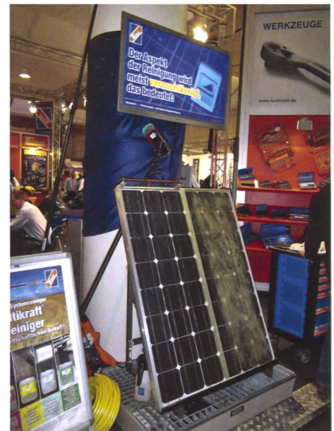
Wascheinrichtung für verschmutzte Photovoltaikpanels.
