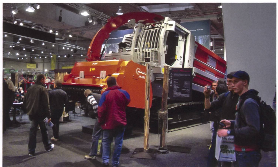
Biomasse Harvester erntet, zerkleinert und transportiert hochwachsende und bodennahe Biomasse.
