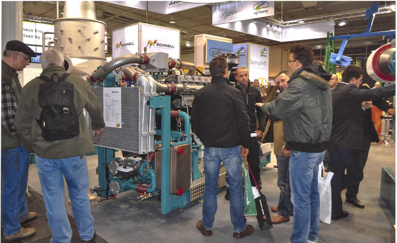
Stromproduktion aus erneuerbarer Energie grossgeschrieben: BHKW (Blockheizkraftwerk), betrieben mit Biogas. (Bilder: Paul Müri)
