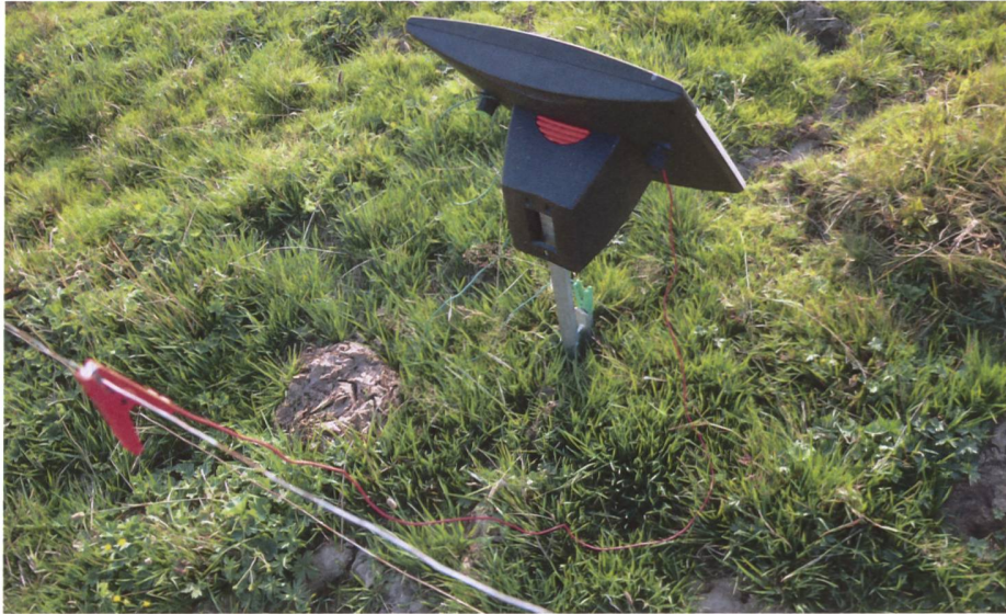
Beispiel einer Inselanlage mit Energiespeicher: Viehhüteapparat mit Solarpanel und Speicherakku. Die Kosten für den Akkumulator machen bis 40% der Investitionskosten aus (periodischer Ersatz notwendig).
