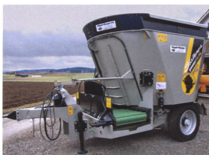
Der Powermix-Mischwagen von Shelbourne vermengt die unterschiedlichsten Futtermittel; Wurzeln werden zerkleinert und mit anderen Zutaten in einem Durchgang gemischt. Selbst Grossballen von Heu, Stroh oder Silage können als Ganzes in den Mischwagen gegeben werden.
