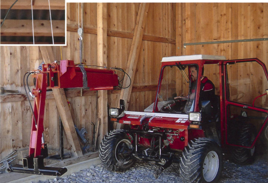
Ist der Teleskoparm abgebaut, benötigt er in der Scheune nur sehr wenig Platz. Der Anbau dauert nur 10 Minuten und erfordert keine Werkzeuge
