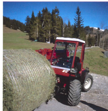
Der Metrac ist dank Allradlenkung wendig.
