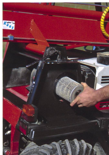
Der Teleskoparm ist an einem Rahmen mit Aussparung für den Luftfilter montiert.
