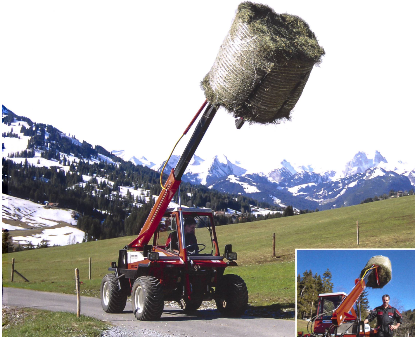
Der Teleskoparm am Zweiachsmäher von Rolf Kunz besticht nicht nur durch eine beachtliche Hubhöhe, sondern auch durch eine sehr grosse Überladeweite.
