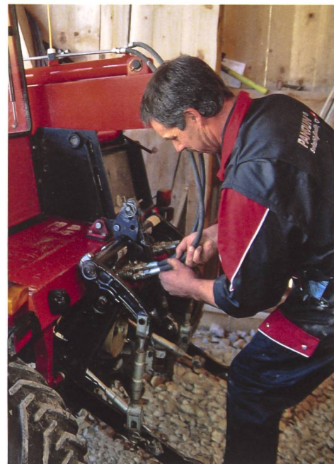
Alle Leitungen der hydraulischen Funktionen werden hinten angekuppelt.
