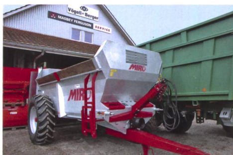
Der Miststreu von Heywang Miro mit verzinkter einteiliger Stahlmulde samt integriertem Chassis sowie Kratzboden mit hydraulischem Vorschub über die Traktorhydraulik.
