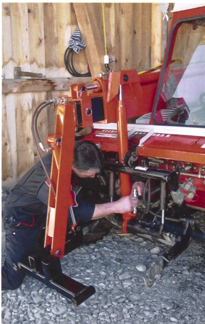
Zum Ankuppeln des Hubzylinders wurde unter der Kabine eine Leitung gezogen.
