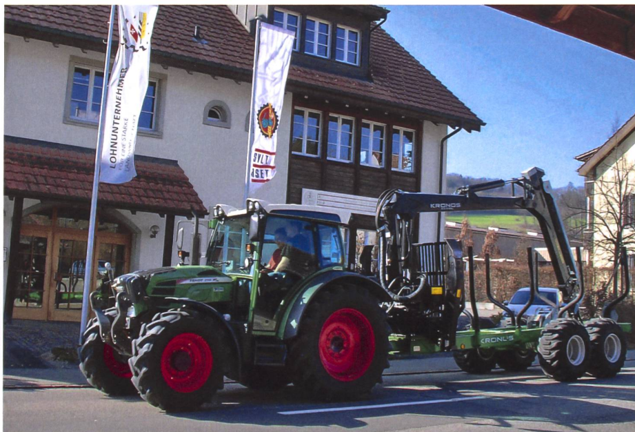
Fendt 210 Vario TMS, als Getriebebeispiel der hydrostatisch-mechanischen Leistungsverzweigung ausgangsgekoppelt, bei der Durchfahrt vor dem Hauptsitz des Schweizerischen Verbandes für Landtechnik. (Bilder: Dominik Senn)
