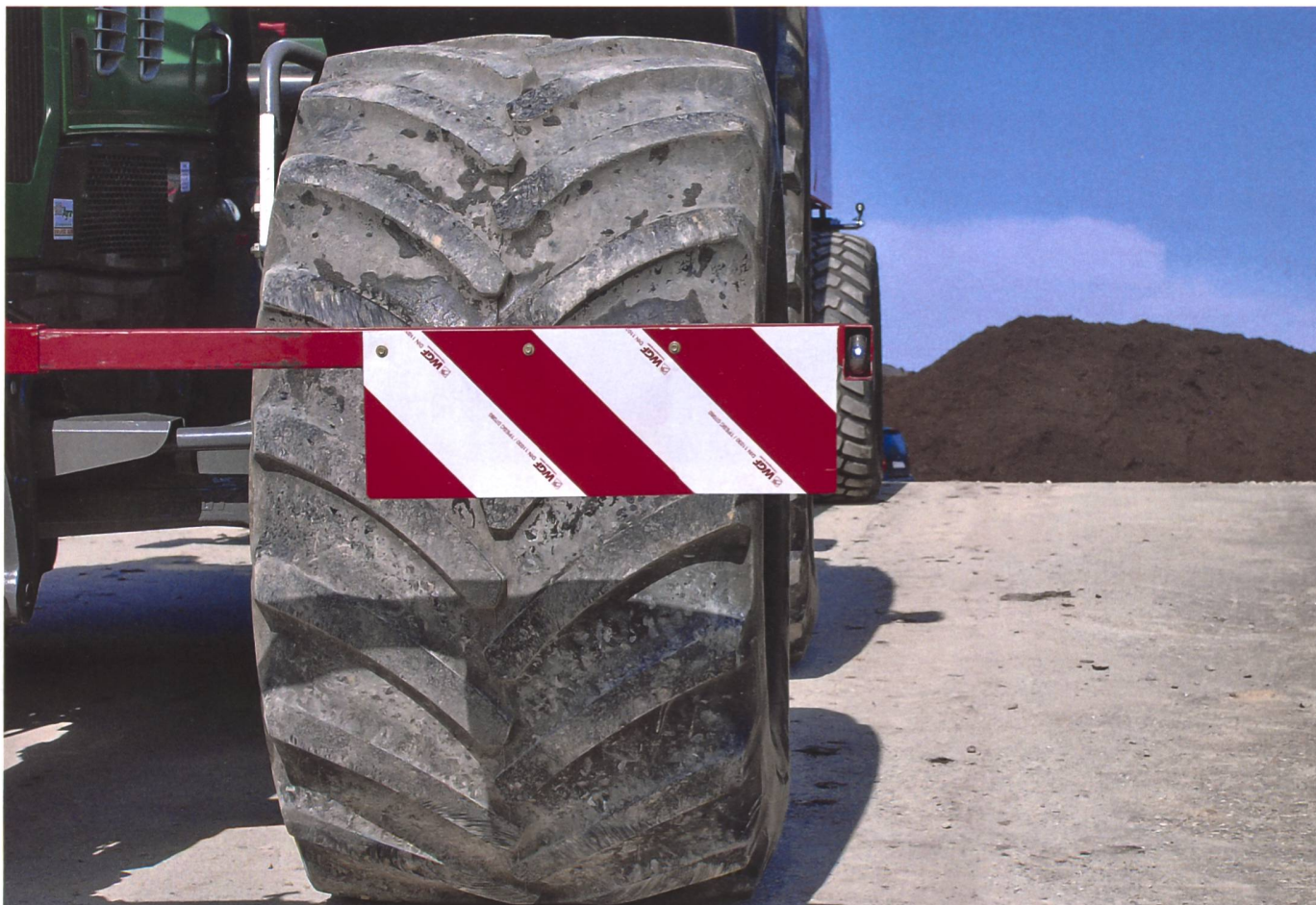
Mit 750er-Bereifung darf dieser Traktor nun auch breitere Anhänger ziehen, wenn die Breite des Anhängers auffällig am Traktor markiert ist. (Bild: Dominik Senn)
