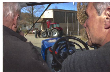
Instruktion auf einem New Holland T7.170 als Getriebebeispiel der mechanisch-mechanischen Leistungsverzweigung, dahinter ein Case Steyr 160 CVX als Beispiel der hydrostatisch-mechanischen Leistungsverzweigung eingangsgekoppelt.
