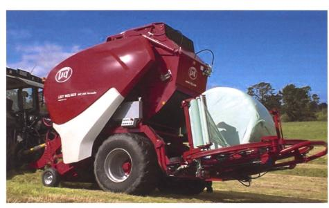
Die «RPC 445 Tornado» von Lely Welger ist eine einzigartige Presswickelkombination mit variabler Kammer, CPS-System und für den Transport aufklappbarem Wickeltisch.
