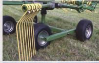
Kreiselschwader, schieben das Erntegut mit 6–7,5 m/s über den Boden. Die Zinkenform unterscheidet sich von Hersteller zu Hersteller.
