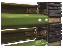
Bei den Typen Comprima und Ultima setzt Krone anstelle vom Kettenelevator den NovoGrip-Gurt-Stab-Elevator ein.
