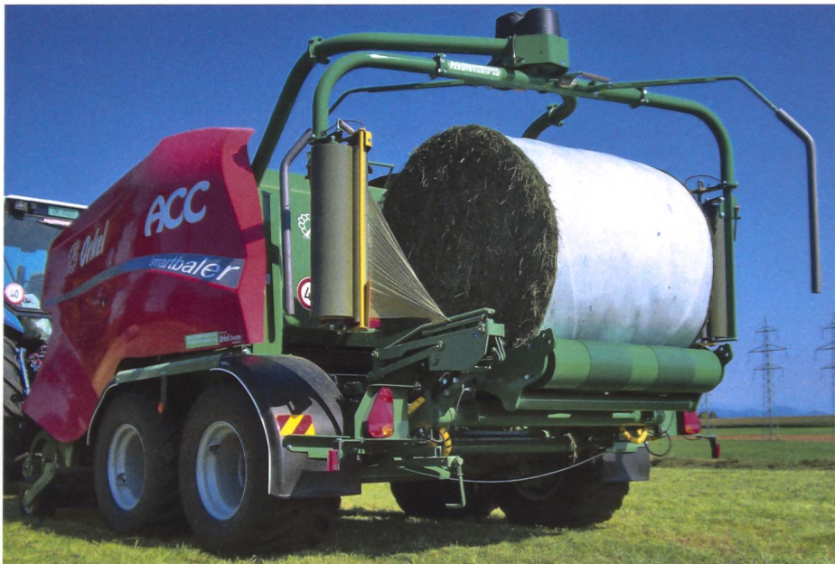
Mit dem HiQ Smartbaler bietet Orkel die erste und einzige Presswickelkombination an, die den Ballen mit Netz oder Mantelfolie binden kann.
