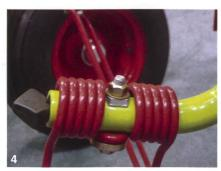
Fella betont, dass nur mit gleichschenkligen Zinken eine optimale Durchmischung des Mähgutes möglich sei. Die verwendeten Zinken sind neuneinhalb Millimeter dick, haben insgesamt sechs Federwindungen mit einem Durchmesser von 70 Millimetern. Mit Ausnahme des kleinsten Modells sind alle Zettwender von Fella mit einer Zinkenverlustsicherung ausgerüstet.
