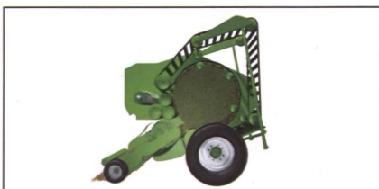
Die semivariable Ballenkammer von Krone arbeitet nach dem Festkammerprinzip. Beim Start (links) ist die Kammer eckig. Nach dem Erreichen des Normalformats (Mitte) hebt sich das Pressorgan über die Führungsrollen ab und ermöglicht einen grösseren Durchmesser (rechts).
