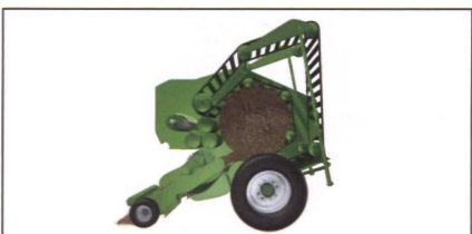
Die semivariable Ballenkammer von Krone arbeitet nach dem Festkammerprinzip. Beim Start (links) ist die Kammer eckig. Nach dem Erreichen des Normalformats (Mitte) hebt sich das Pressorgan über die Führungsrollen ab und ermöglicht einen grösseren Durchmesser (rechts).
