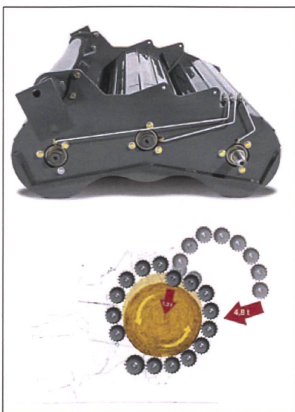
Beim System MPS II von Claas wird auf drei Walzen zusätzlichen Druck ausgeübt.
