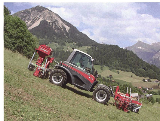
In Hanglagen erleichtert eine Kombination aus Front- und Heckgeräten die Fahrweise und erfordert weniger schwere Traktoren.
