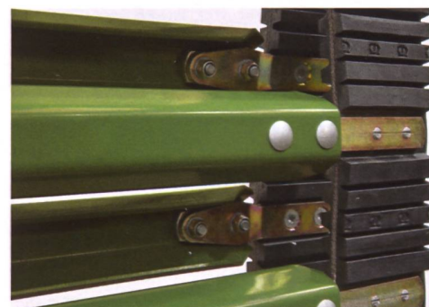
Bei den Typen Comprima und Ultima setzt Krone anstelle vom Kettenelevatorsystem den NovoGrip-Gurt-Stab-Elevator ein.
