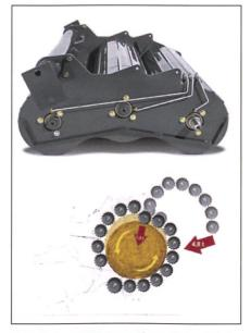
Beim System MPS II von Claas wird auf drei Walzen zusätzlichen Druck ausgeübt.
