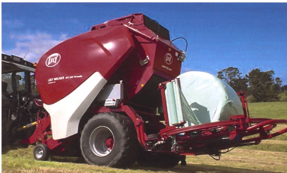
Die «RPC 445 Tornado» von Lely Welger ist eine einzigartige Presswickelkombination mit variabler Kammer, CPS-System und für den Transport aufklappbarem Wickeltisch.
