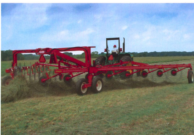
Einfachheit in ihrer Konstruktion und beachtliche Flächenleistungen zeichnen Sternradrechen aus. (Werkbild)
