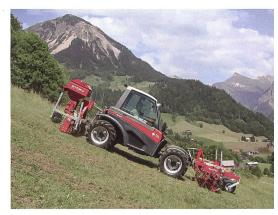
In Hanglagen erleichtert eine Kombination aus Front- und Heckgeräten die Fahrweise und erfordert weniger schwere Traktoren.
