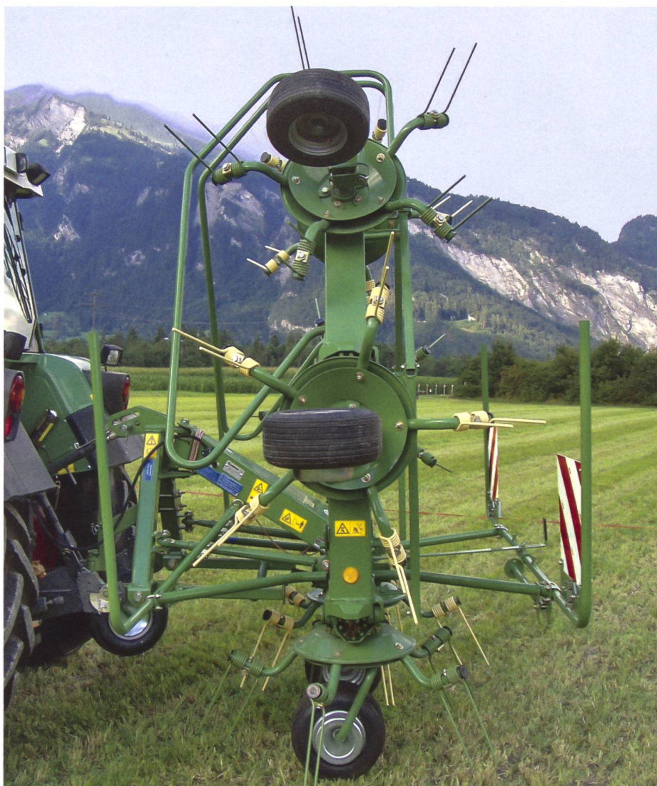
Mit unterschiedlicher Farbgebung unterscheidet Krone links- und rechtsdrehende Zinken.
