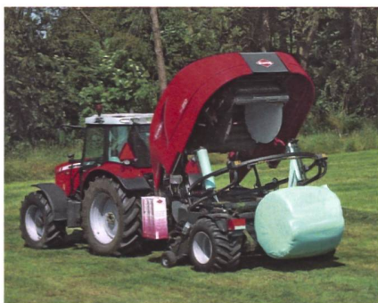
Die «IBIO» von Kuhn ist die einzige Kombination, die in der Presskammer auch wickelt.
