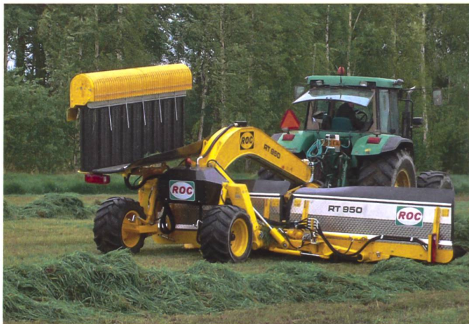
Bandschwader sind leistungsfähig, flexibel, aber auch entsprechend teuer in der Anschaffung. (Werkfotos)
