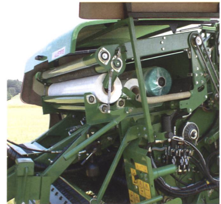
In der Vorratskammer kann man Netz und Mantelfolie gleichzeitig mitführen.
