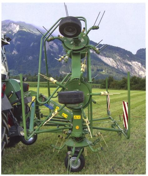
Mit unterschiedlicher Farbgebung unterscheidet Krone links- und rechtsdrehende Zinken.
