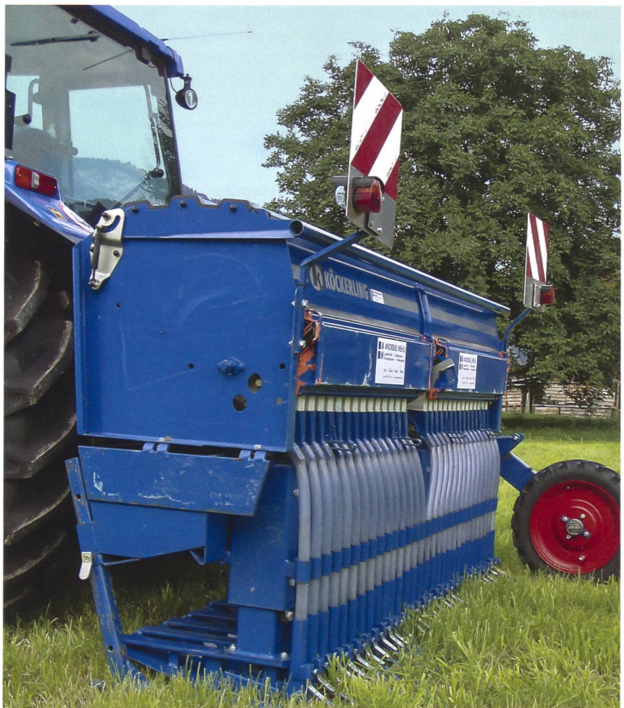
Der Herbamat von Köckerling ritzt den Boden auf und streicht die Rille nach der Saatgutablage wieder zu.
