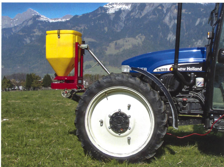
In Kombination mit einer Walze oder Wiesenegge im Heck können auch Sägeräte für Feinsämereien eingesetzt werden.
