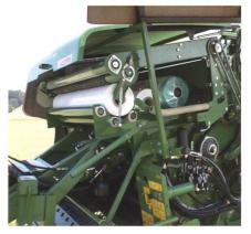
In der Vorratskammer kann man Netz und Mantelfolie gleichzeitig mitführen.
