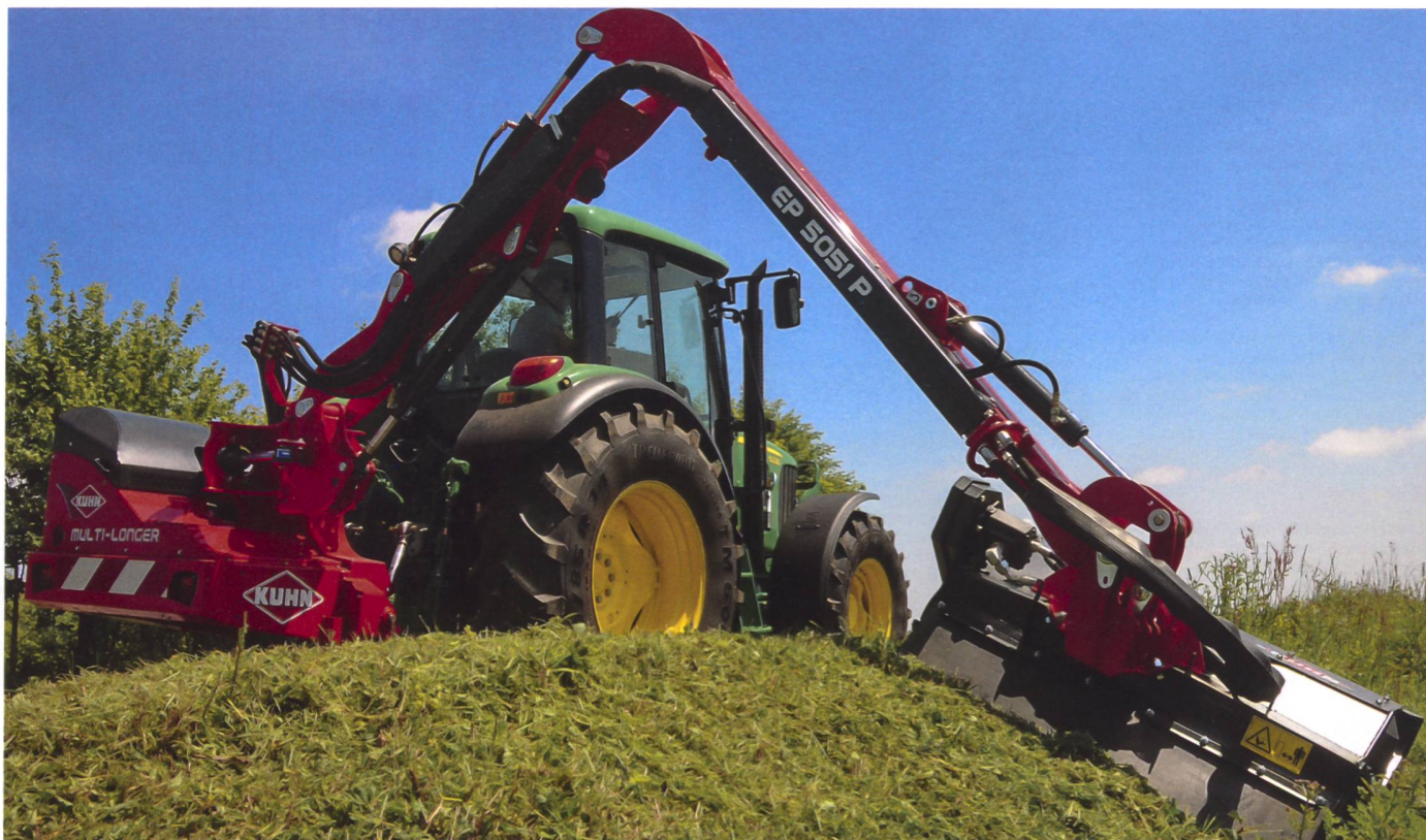
Durch die seitliche Arbeitsweise werden besonders die Anbauteile am Traktor stark belastet.
