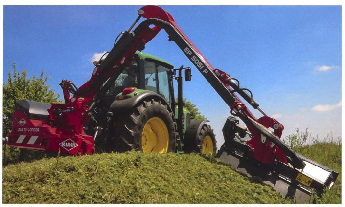
Durch die seitliche Arbeitsweise werden besonders die Anbauteile am Traktor stark belastet.
