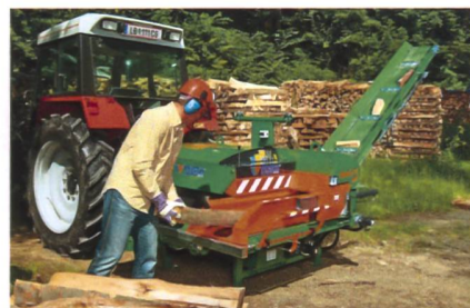
Rationelle Brennholzaufbereitung mit der AutoCut 700 von Posch im Programm von Althaus.
