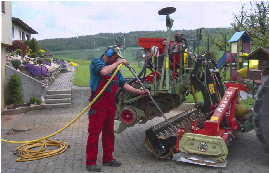
Bei Reinigungs- und Wartungsarbeiten müssen alle Antriebe ausgeschaltet sein. Arbeiten unter der Maschine dürfen nur ausgeführt werden, wenn diese gegen Absenken gesichert ist.
