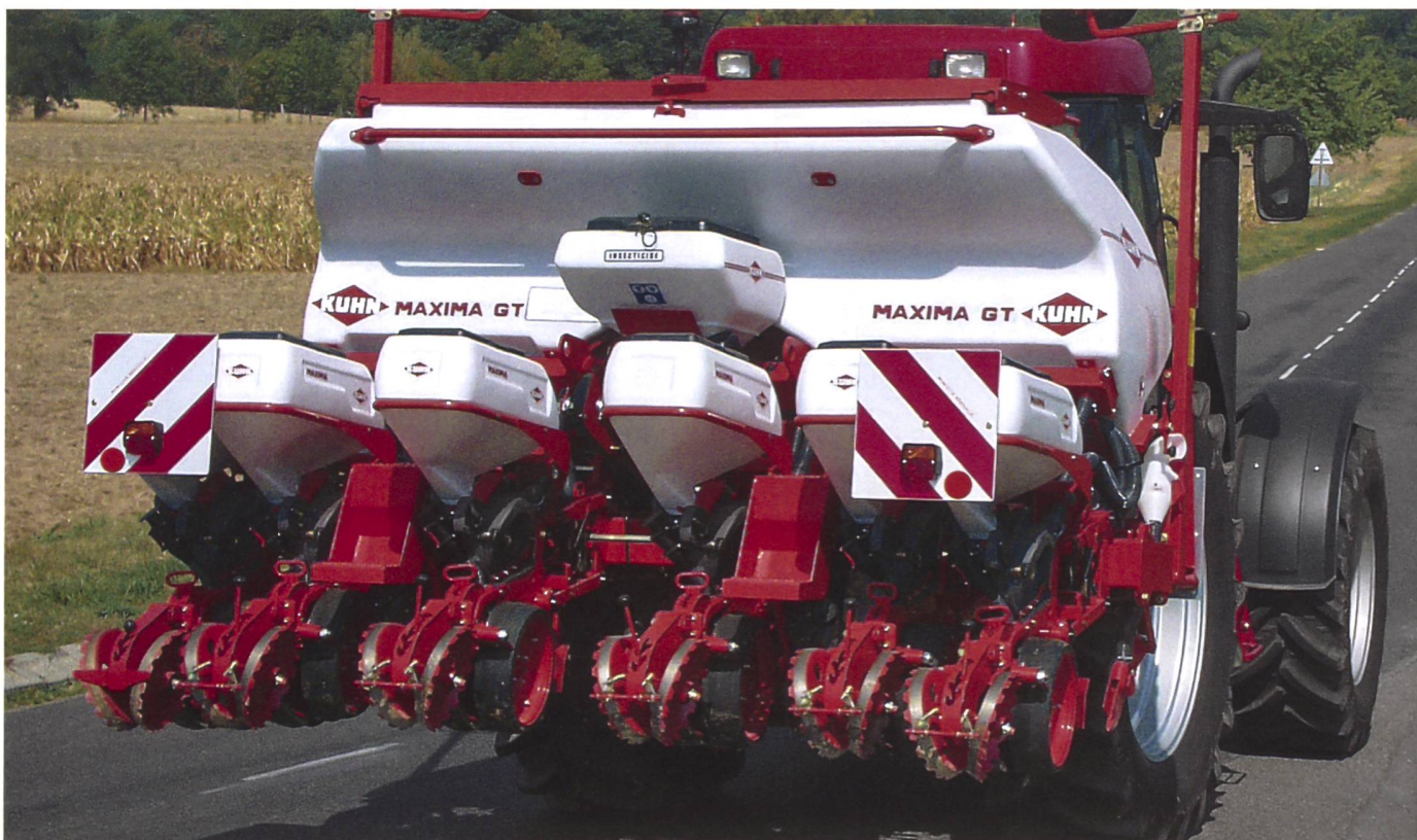
Anbaugeräte an landwirtschaftlichen Motorfahrzeugen sind bis zu einer Breite von 3,5 m gestattet, die Breite wird durch rot-weiße Tafeln markiert.
