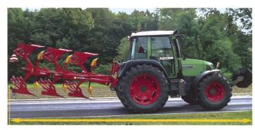
Die Länge von Motorfahrzeugen mit Zusatzgeräten darf max. 12 m betragen. Fahrzeugteile oder Zusatzgeräte dürfen gemessen ab Mitte Lenkrad bis 4 m nach vorne reichen. Ein Seitenblickspiegel ist erforderlich, wenn diese Distanz 3 m übersteigt. (Bilder: BUL)
