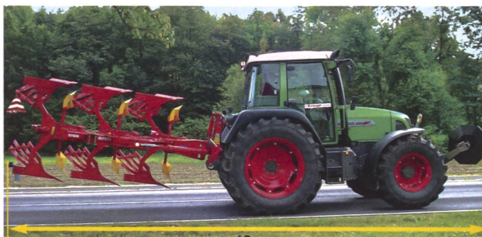
Die Länge von Motorfahrzeugen mit Zusatzgeräten darf max. 12 m betragen. Fahrzeugteile oder Zusatzgeräte dürfen gemessen ab Mitte Lenkrad bis 4 m nach vorne reichen. Ein Seitenblickspegel ist erforderlich, wenn diese Distanz 3 m übersteigt. (Bilder: BUL)
