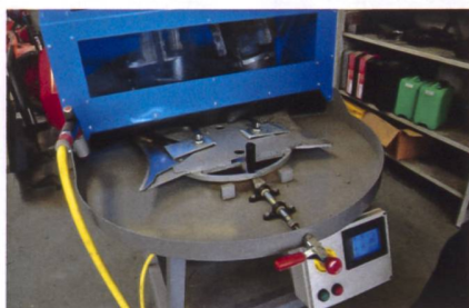
Beim Schleifautomaten «Autogrind» spannt man jedes Messer einzeln mit einer Schablone ein.
