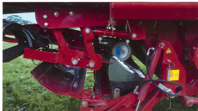
«Auto Cut» von Pöttinger ist bisher die einzige Schleifmaschine, die Messer ohne Demontage schleifen kann.
