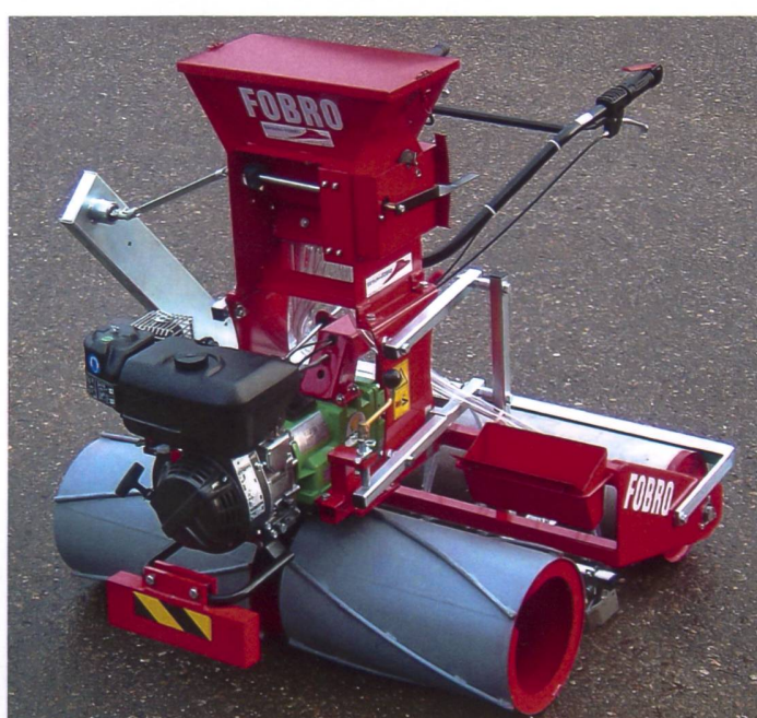
Aufgeschweisste Rippen sichern der Antriebswalze genügend Adhäsion.
