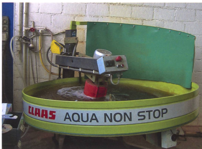
Beim «Aqua Non Stop» von Claas arbeitet der Schleifstein direkt im Wasserbad.
