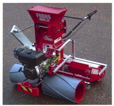
Aufgeschweisste Rippen sichern der Antriebswalze genügend Adhäsion.
