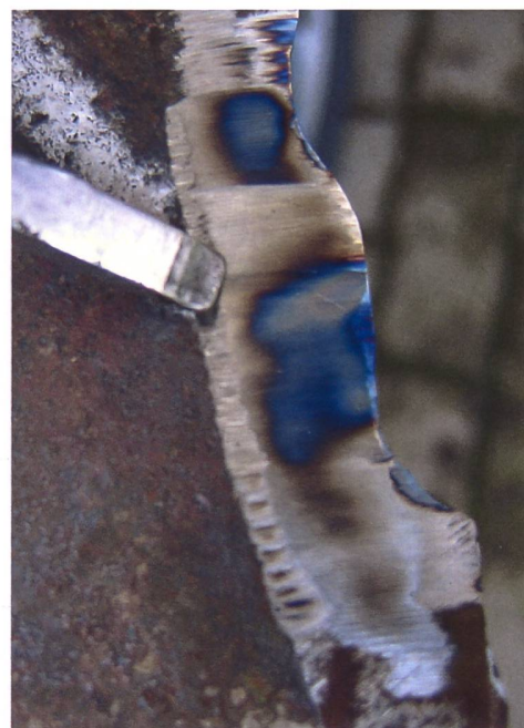
Beim Trockenschliff können sich die Messer stark erwärmen und dadurch an Härte einbüßen.
