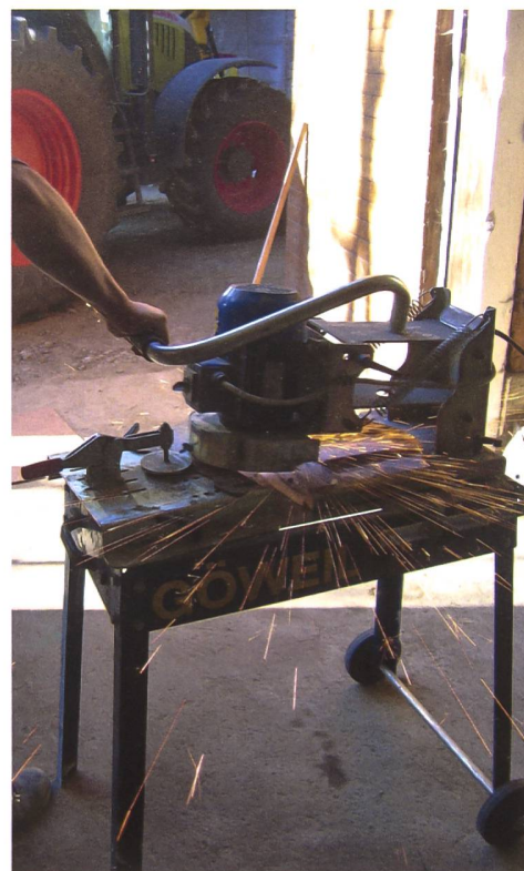
Als günstige Variante zum Winkelschleifer bieten sich «herkömmliche» Trockenschliffgeräte an
