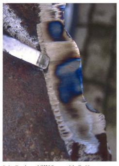
Beim Trockenschliff können sich die Messer stark erwärmen und dadurch an Härte einbüssen.
