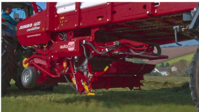
«Auto Cut» von Pöttinger ist bisher die einzige Schleifmaschine, die Messer ohne Demontage schleifen kann.
