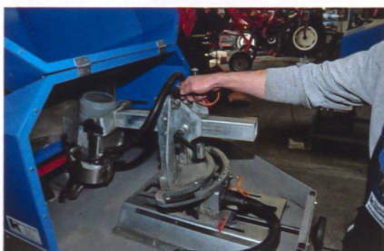
Beim Schleifautomaten «Autogrind» spannt man jedes Messer einzeln mit einer Schablone ein.
