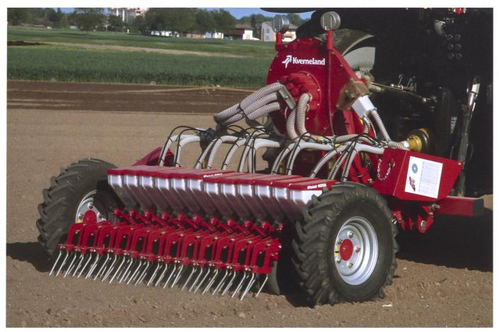
Traktorgezogene pneumatische Gemüsesämaschine von Kverneland.
