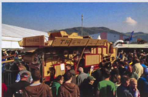
Die Dreschmaschine wurde über einen Transmissionsriemen von einem Lanz Bulldog betrieben.
