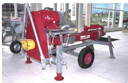
Schneckenpumpe mit kombiniertem Elektro-/Zapfwellenantrieb, nicht sichtbar ist die aufgebaute Funkfernsteuerung.
