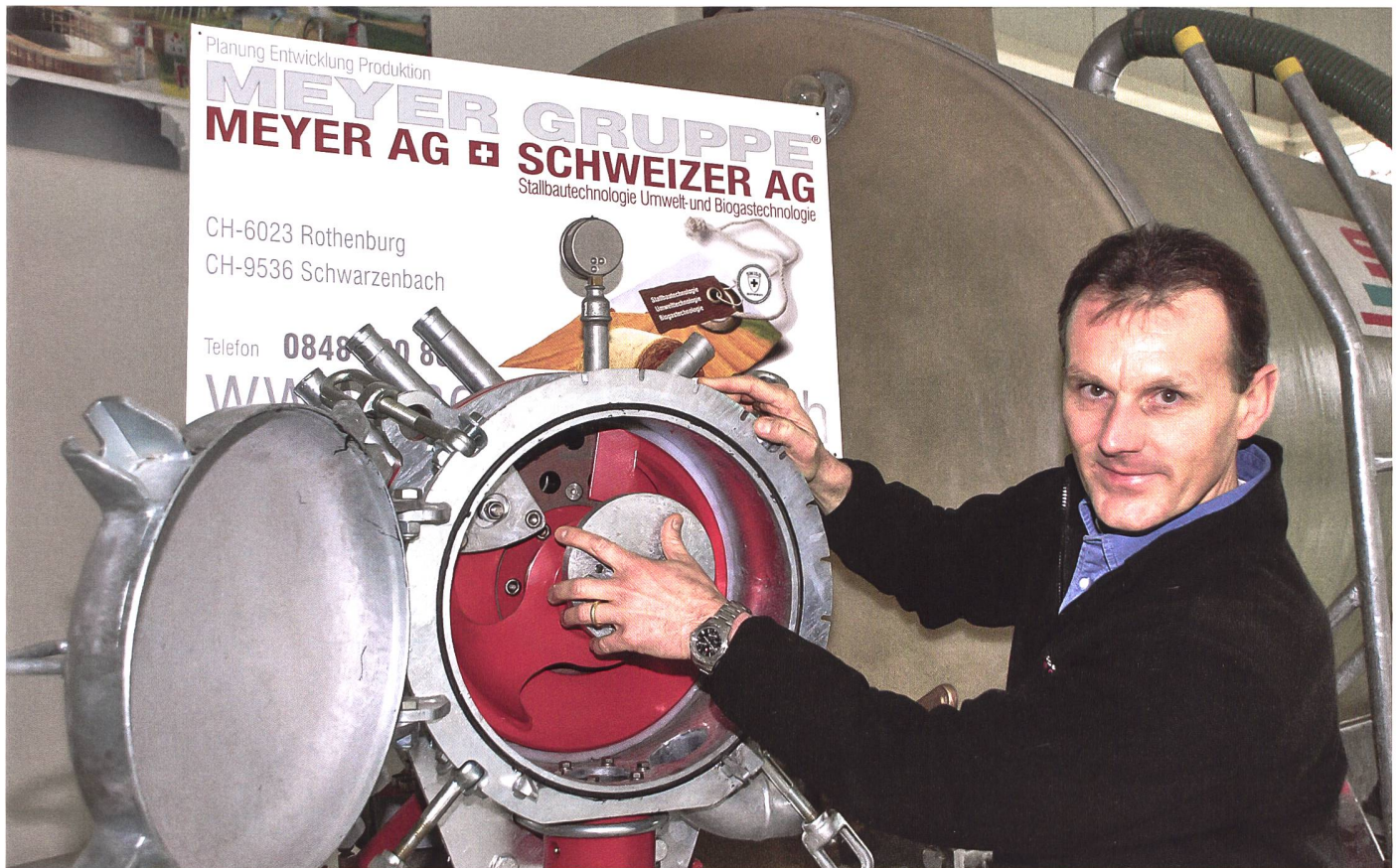
CEO Stephan Meyer erklärt die Funktionsweise des hauseigenen patentierten Verteilkopfes, der auch dicke Gülle und langes Stroh bewältigt. (Bilder: Schweizer AG/Dominik Senn)
