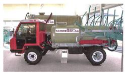
Aufbaupumpfass mit dem rundgewickelten Polyestertank und Spannbändern für die optimale Tankbefestigung.
