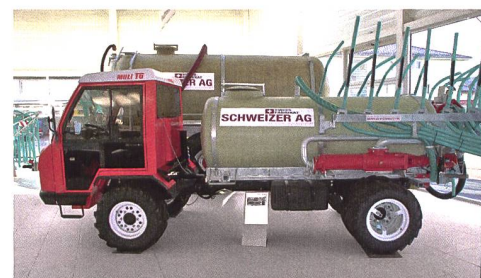
Aufbaupumpfass mit dem rundgewickelten Polyestertank und Spannbändern für die optimale Tankbefestigung.
