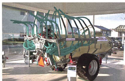
Einachsiger traktorgezogener Pumptankwagen mit einer Transportkapazität bis 25 000 Liter.
