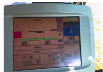
Auf dem GreenStar-2600-Display von John Deere ist sichtbar, welche Teilbreiten gerade ein bzw. ausgeschaltet sind.
