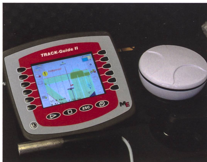
Auf dem hoch auflösenden Bildschirm des «Track Guide II» kann der Fahrer auf einen Blick sehen, wo er mit der Bearbeitung des Feldes steht.
