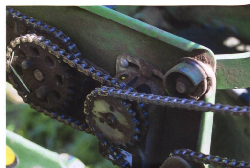
Beim «Row Command» von John Deere werden die Säereien mittels elektrisch geschalteter Kupplungen im Kettenantrieb ein- und ausgeschaltet.
