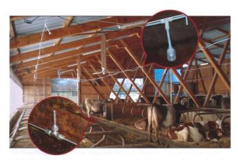
Abb. 3: Die Messanordnung im Stall bestand aus der Zudosierung von Tracergasen über ein Rohrsystem mit Kapillaren an den emittierenden Laufflächen und einem Luftsammelsystem mit Kapillaren in drei Meter Höhe jeweils an vielen Orten.
