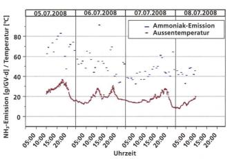
Abb. 7: In der Sommermessung folgte das Niveau der NH₃-Emissionen der Temperatur im Tagesverlauf.
