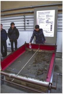
Abflussversuch auf dem Modell einer geneigten Lauffläche (3% Gefälle). Wenn die Fläche sauber ist, kann Harn ungehindert abfliessen.
