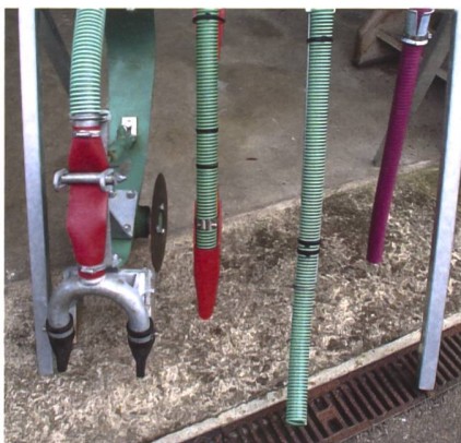
Gülle-Ausbringetechniken im Grünland: Schlitzdrill, Schleppschuh und Schleppschläuche. Je schneller die Gülle in den Boden eindringt, desto geringer sind die Emissionen. In den Niederlanden ist die Verwendung von Schlitzdrillen vorgeschrieben. Die Emissionsreduktion beträgt bei Schlitzdrill 60–80%, beim Schleppschuh 40–70% und beim Schleppschlauch 30–60%.
