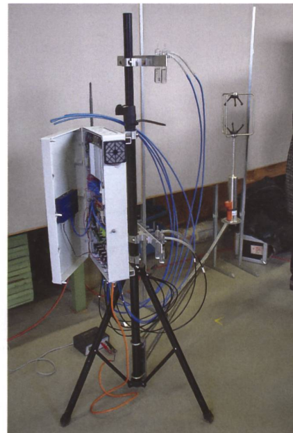
Gerät zur Messung der Ammoniakkonzentration in der Luft kombiniert mit einem Windsensor.
