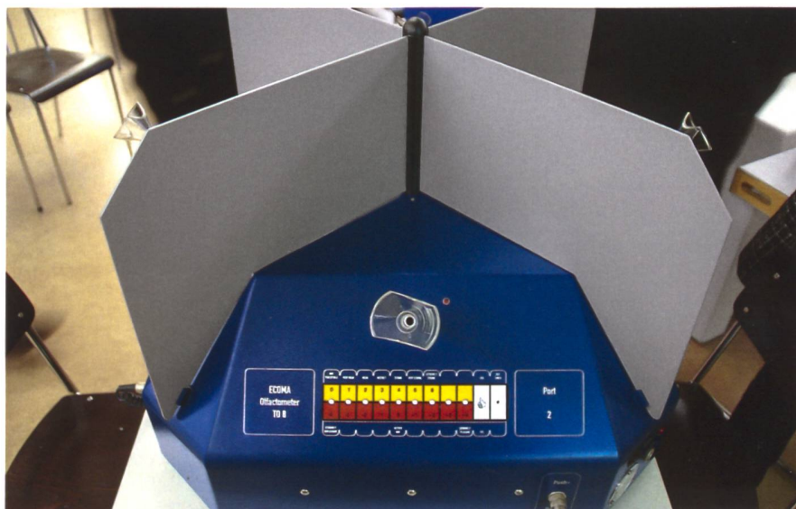
Am Olfaktometer riechen Testpersonen die Luftprobe und bewerten den Geruch.
