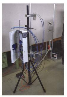
Gerät zur Messung der Ammoniakkonzentration in der Luft kombiniert mit einem Windsensor.
