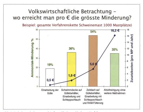
Abb. 3: Emissionsminderung und Aufwand bei verschiedenen Verfahren (Quelle: Grimm 2010, KTBL)
