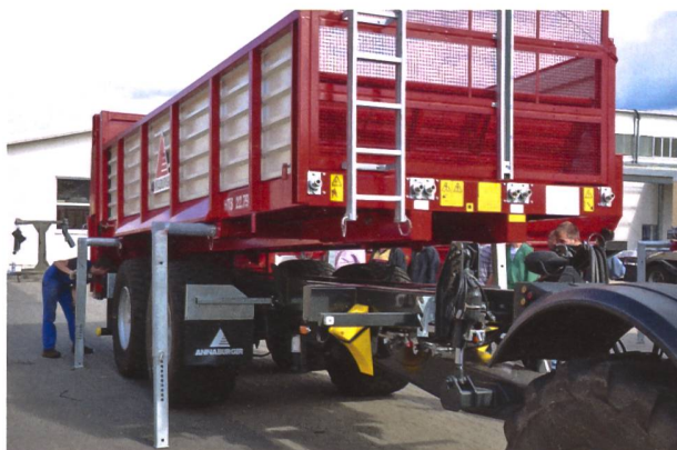
Mit einem Wechselsystem können die verschiedensten Aufbauten genutzt werden. Foto Ruedi Hunger.
