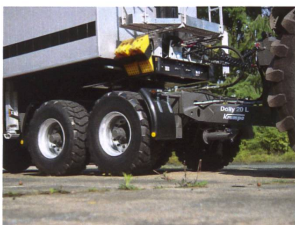
Ein Dolly überträgt eine beachtliche Stützlast auf den Traktor, dennoch wird aus dem Traktor kein Lastwagen. Werkfoto Krampe.
