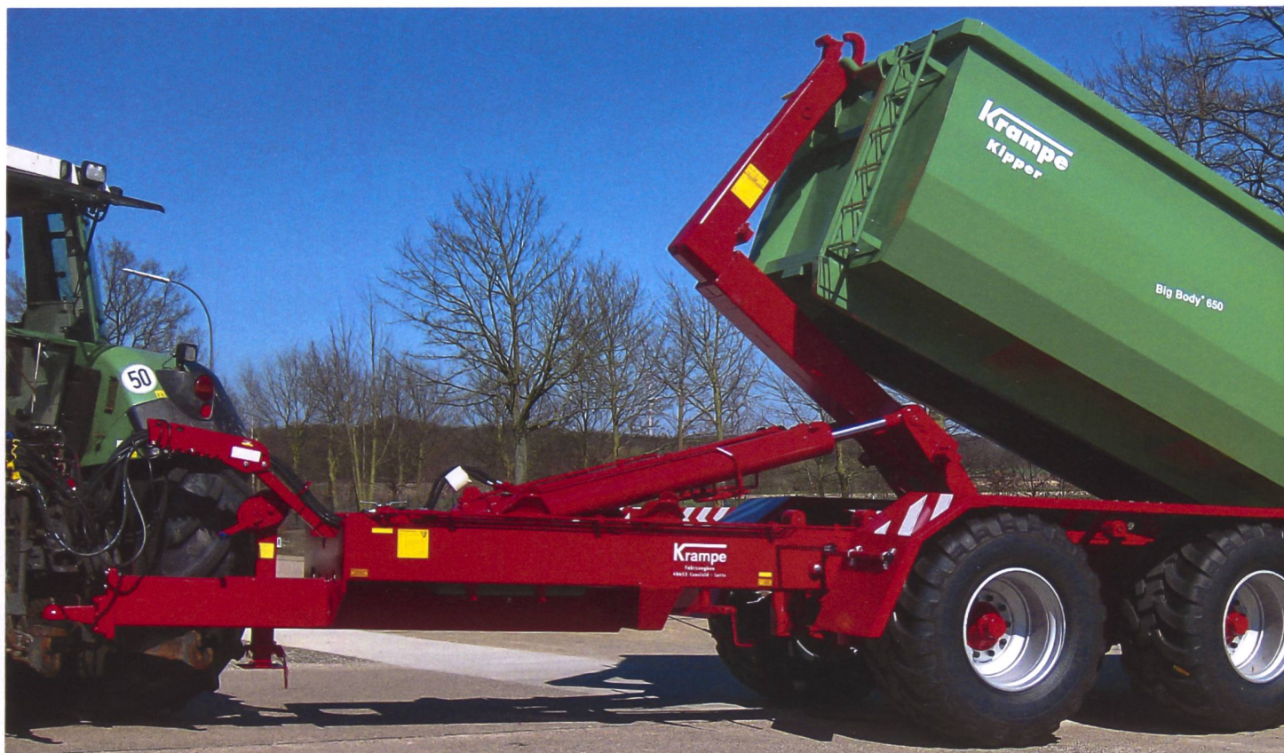
Ein Abrollcontainer mit hydraulisch klappbarer Rückwand macht das Liftsystem zum vollwertigen Kipper. Foto: Werkfoto Krampe.
