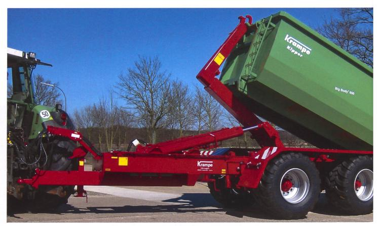
Ein Abrollcontainer mit hydraulisch klappbarer Rückwand macht das Liftsystem zum vollwertigen Kipper. Foto: Werkfoto Krampe.
