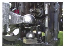
Für neue Transportsysteme taugt nur noch die Kugelkopfkupplung mit 80 mm Durchmesser. Foto Ruedi Hunger.
