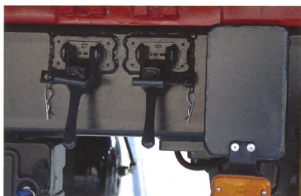
Doppelte Exzenterverschlüsse verspannen die Wechselaufbauten mit dem Transportchassis. Foto Ruedi Hunger.
