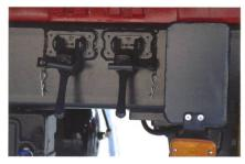
Doppelte Exzenterverschlüsse verspannen die Wechselaufbauten mit dem Transportchassis. Foto Ruedi Hunger.
