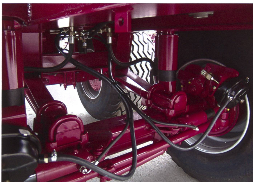
Das Fahrwerk ist mit einer hydropneumatischen Federung ausgerüstet und bietet guten Fahrkomfort und Stabilität am Hang.
