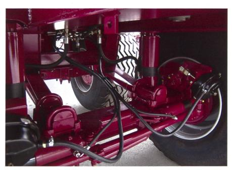
Das Fahrwerk ist mit einer hydropneumatischen Federung ausgerüstet und bietet guten Fahrkomfort und Stabilität am Hang.
