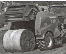
Bereits haben Orkel-Pressen in der Schweiz über 300 000 Gras-Rundballen mit dem neuen F&F-System gepresst. Alle Pressen der Smartbaler-Reihe von Orkel sind mit der HiT-Folienbindung ausgerüstet. Mit der einzigartigen ACC-Pressdruckregelung wird eine unübertroffene Pressdichte erreicht. Unverwüstliche Gleitlager, 20-Messer-Schneidwerk, Wickelkombi mit nur 275 cm Breite und 4700 kg Gewicht, automatische Siliermitteldosierung (Liter/Ballen) sind nur einige Besonderheiten dieser Pressenreihe.
