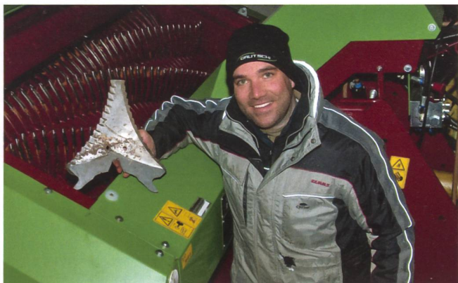
Reto Gautschi kann die 45 doppelseitigen Messer des Kurzschnittladewagens in 10 bis 15 Minuten wenden.
