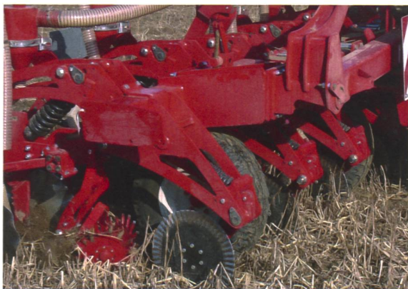
Beim absätzigen Strip-till-Verfahren werden die bearbeiteten Streifen in abgefrorene Pflanzen oder Ernterückstände gelegt.
