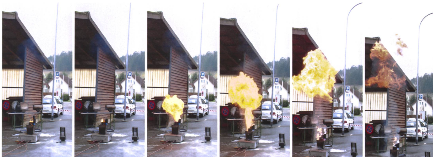
Das Wasser im Behälter über dem brennenden Friteusenöl wird per Kettenzug ins Öl gekippt, die Reaktion startet mit einem Wummen, die Flamme steigt meterhoch und verpufft.
