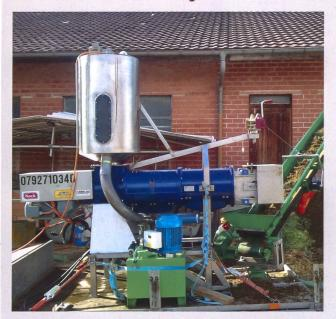
Die Beschickung dieser bei Yves Leuenberger in Bennwil BL stationierten Kombination erfolgt über eine Turbotauchpumpe (Zentrifugalpumpe) mit Schneidwerk und hydraulischem Antrieb. Ein aufgebautes Hydraulikaggregat mit Elektroantrieb erzeugt den Ölstrom. Durch einen Mengenteiler ist es möglich, die Fördermenge an die Leistung des Separators anzupassen. Auf der Maschine
