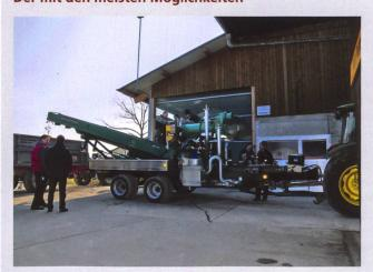
Der mobile Separator des Lohnunternehmens Flury und Emch aus Halten SO ist mit einer sehr umfangreichen Ausrüstung ausgestattet. Für die Förderung der Gülle ist eine Drehkolbenpumpe mit drei Kammern aufgebaut: Die erste fördert die Dickgülle, die zweite die Gülle aus dem Überlauf zurück in den Ansaugbehälter und die dritte die separierte Dünngülle. Dadurch kann diese Maschine
