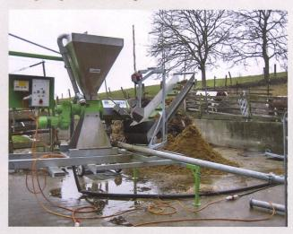
Dieser mobile Separator wurde von der Keller Technik AG, Nussbaumen, gebaut, wird zurzeit vermietet und steht zum Verkauf. Eine erste Besonderheit dieser Anlage ist die Beschickung. Die Anlage wurde gezielt so gebaut, dass zwischen Rohgüllelager und Separator nur ein flexibler Schlauch erforderlich ist. Dazu wird eine Tauchschneidpumpe im Rohgüllelager eingesetzt. Das hat den Vorteil, dass keine formstabilen Saugschläuche mitgeführt werden müssen. Bei dieser
