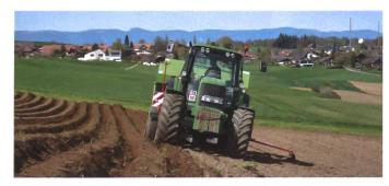
Die Kartoffelablage ist auch am Hang stets in der Furchenmitte, die Ablagetiefe dank Tiefenführung über die gross dimensionierte Bereifung der Maschine exakt.
