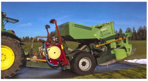
Der hydraulische Zugzylinder hebt die Negativstützlast weitestgehend auf. Vorne auf der Maschine sichtbar die Beizvorrichtung. Das Befüllen geschieht in der Regel mittels Heckstapler, Frontlader oder Teleskoplader. Der Pflanzbunker bietet bis zu drei Tonnen Saatkartoffeln Platz.
