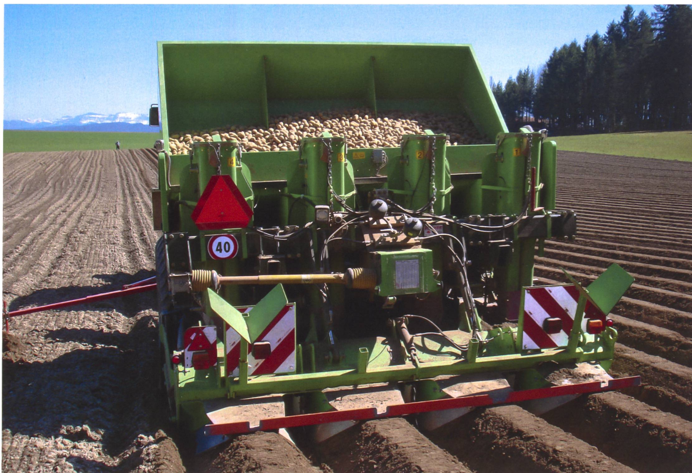
Der Damm wird beim «All-in-One»-Verfahren direkt fertig aufgebaut. Das ergibt somit ein längeres Zeitfenster zur Unkrautbekämpfung. (Bilder: Samuel Guggisberg/Dominik Senn)
