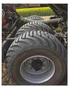
Das überdimensionierte Fahrwerk sorgt für eine optimale Tiefenführung der Maschine und für ein Vorbrechen der Ackerkrumme.
