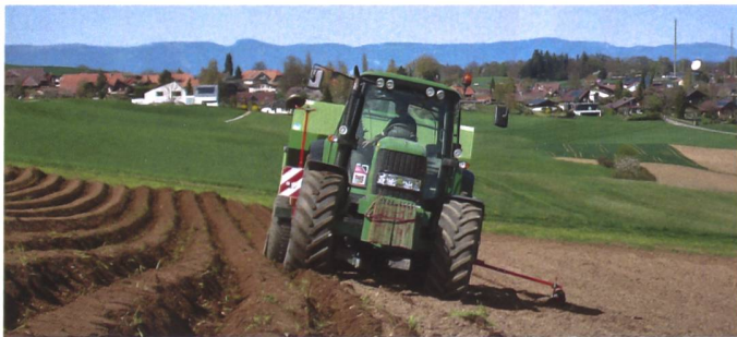
Die Kartoffelablage ist auch am Hang stets in der Furchenmitte, die Ablagetiefe dank Tiefenführung über die gross dimensionierte Bereifung der Maschine exakt.
