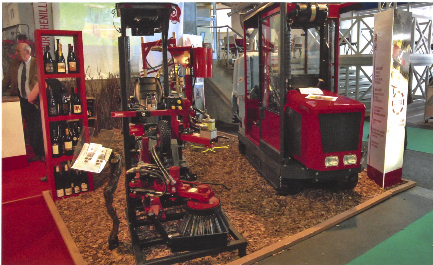
Mechanische Unkrautbekämpfung zwischen den Reihen im Weinbau mittels langsam drehender Metallbürste des französischen Herstellers Naturagriff, in der Schweiz vertreten durch Loeffel & Cie in Boudry NE. (Bilder: Monique Perrottet)
