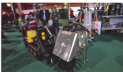
Zahlreiche Hersteller, wie Chappot SA, Charrat VS (Bild), bieten Raupenfahrzeuge an. Deren Polyvalenz für den Einsatz sowohl beim Auslichten, bei der Bodenbearbeitung als auch als Transportfahrzeug trägt dank unterschiedlichen Aufbauten auch auf absoluten Steillagen zu einer kostengünstigen Mechanisierung bei.
