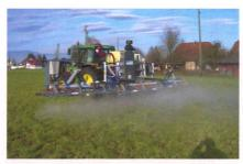
Durch elektrostatische Aufladung können sehr feine Tropfen für einen guten Bedeckungsgrad erzielt werden. Eine Anwendung ist nur bei windstillen Verhältnissen zu empfehlen. (Foto: Agroscope ACW)
