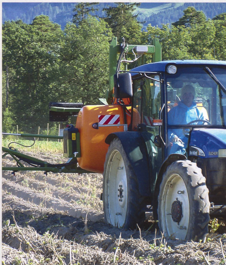
Laut den KIP-Richtlinien müssen selbstfahrende oder zapfwellengetriebene Pflanzenschutzgeräte alle vier Jahre nach den SVLT-Richtlinien geprüft werden.
