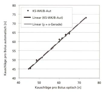
Abb. 6: Zusammenhang zwischen optischer Auszählung (x-Achse) und automatischer Auszählung (y-Achse) für die Anzahl Kauschläge pro Bolus (Punkte, gestrichelte Linie) im Vergleich zur y = x-Geraden (100 % Übereinstimmung graugepunktet).
