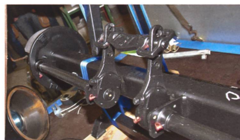
Bei guten Achsen sind generell die Bremswellen gelagert und die Kontaktstellen schmierbar.
