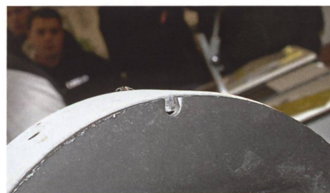
Die Mächtigkeit der Bremsbacke ist dank der Einkerbung auf einen Blick erkennbar.
