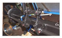
Bei guten Achsen sind generell die Bremswellen gelagert und die Kontaktstellen schmierbar.
