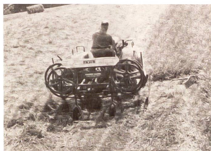
Band- oder Kettenrechen Fahr, zum Zetten, Wenden und Schwaden, hier mit gleichzeitigem Mähen mit dem Fingerbalken.
