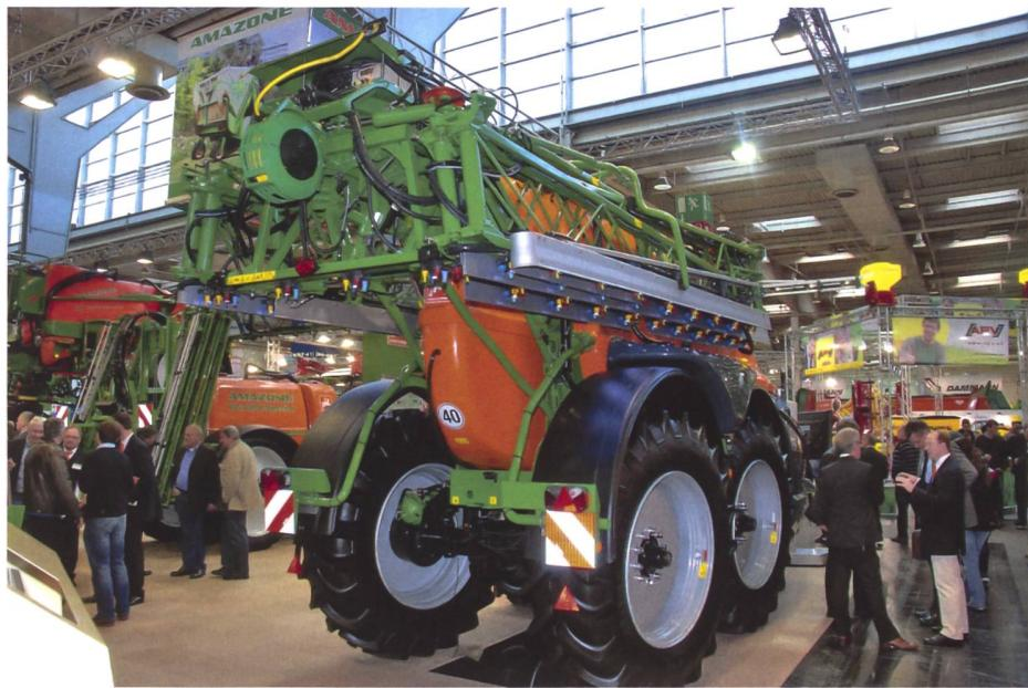
Mit dem 200-PS-Pantera 4001 (8,40 m Länge, 3,80 m Höhe und 2,75 m Breite) rundet Amazone das Maschinenprogramm für den Pflanzenschutz nach oben ab. Ein Multifunktionsgriff mit integrierten Fahrzeug- und Spritzfunktionen dient als Fahrhebel. Die Spritzpumpendrehzahl ist stufenlos einstellbar.
