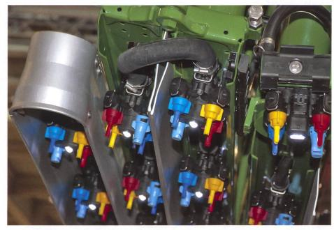
Mit den Injektordüsen des Pantera 4001 von Amazone können Pflanzenschutzmittel abdriftarm ausgebracht werden. Sie sind universell in allen Kulturen einsetzbar. Aufgrund der
