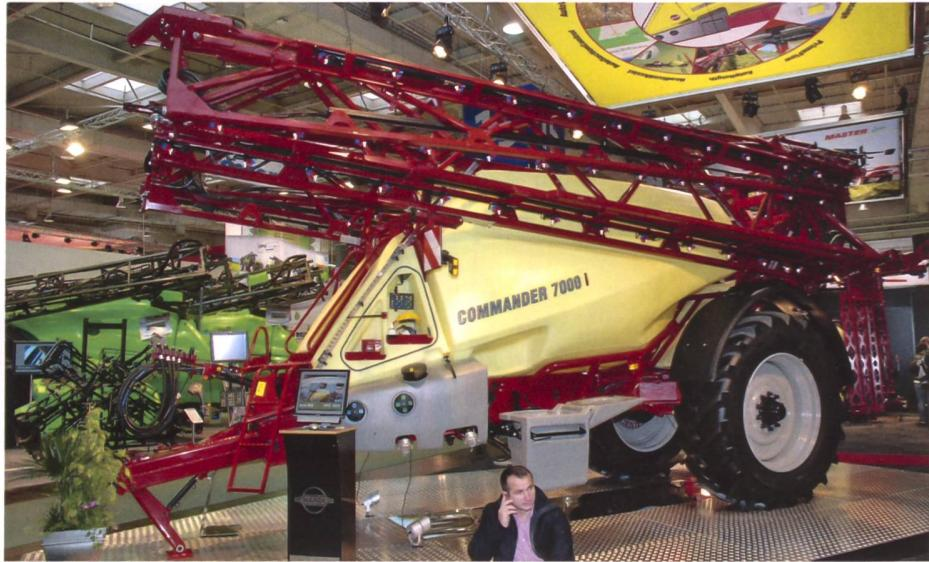
Die Commander-Geräte von Hardi besitzen zwei Axialgebläse. Luftsäcke sorgen für eine gleichmässige Verteilung der Luft über die gesamte Gestängebreite. Die Luft beschleunigt die Spritztropfen und ermöglicht höhere Fahrgeschwindigkeiten. Die Winkelverstellung der Düsen/Lufteinheit ist die Besonderheit der Hardi-Technik.
