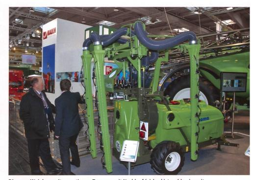
Die neue Weinbauspritze vectis von Tecnoma mit Nachlaufdeichsel ist wahlweise mit Behältergrössen von 800 l, 1000 l oder 1200 l erhältlich. Das abschaltbare Gebläse und das Gestänge sind hinter dem Behälter angeordnet. Die Sprühelemente dienen der beidseitigen Behandlung der Reihen, die Düsenträger sind in Höhe und Spritzwinkel verstellbar. Man kann zwei oder drei Reihen beidseitig behandeln.
