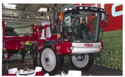
Der Condor von Agrifac besitzt ein Fahrgestell mit Luftfederung, erlaubt eine stufenlose Spurbreitenverstellung von 150 bis 225 cm, optional bis 300 cm, bietet eine Bodenfreiheit von 125 cm (optional: 200 cm), Arbeitsbreiten bis zu 51 m, Behälter bis zu 5000 l und praktisch alle elektronischen Hilfsmittel. Spritzgestänge lassen sich auf Höhen zwischen 50 und 325 cm führen.
