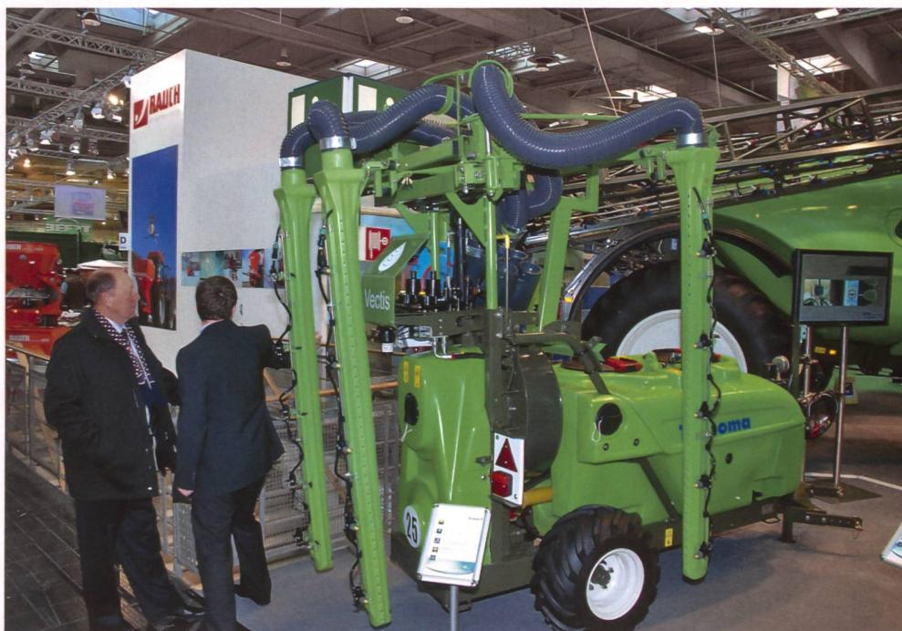
Die neue Weinbauspritze vectis von Tecnomatik ist wahlweise mit Behältergrößen von 800 l, 1000 l oder 1200 l erhältlich. Das abschaltbare Gebläse und das Gestänge sind hinter dem Behälter angeordnet. Die Sprühlemente dienen der beidseitigen Behandlung der Reihen, die Düsenträger sind in Höhe und Spritzwinkel verstellbar. Man kann zwei oder drei Reihen beidseitig behandeln.
