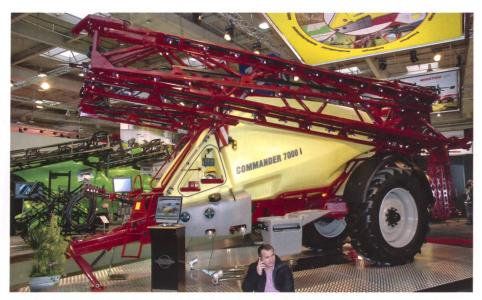
Die Commander-Geräte von Hardi besitzen zwei Axialgebläse. Luftsäcke sorgen für eine gleichmässige Verteilung der Luft über die gesamte Gestängebreite. Die Luft beschleunigt die Spritztropfen und ermöglicht höhere Fahrgeschwindigkeiten. Die Winkelverstellung der Düsen/Lufteinheit ist die Besonderheit der Hardi-Technik.
