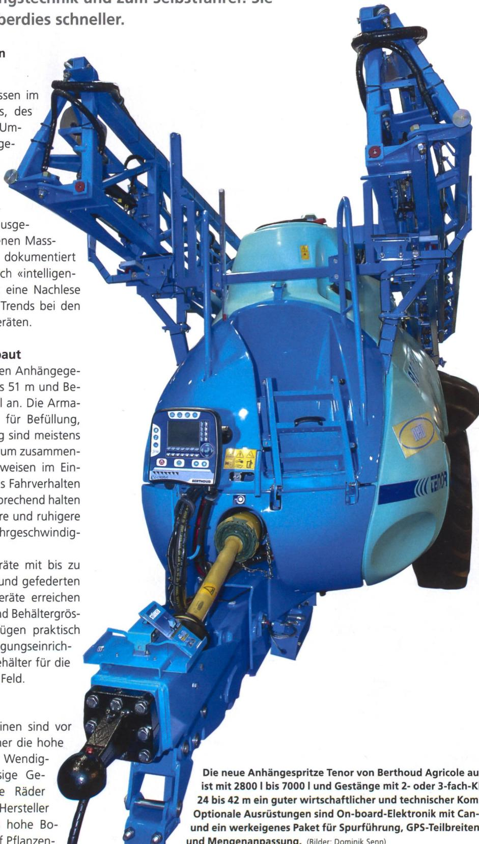
Die neue Anhängespritze Tenor von Berthoud Agricole aus Frankreich ist mit 2800 l bis 7000 l und Gestänge mit 2- oder 3-fach-Klappung von 24 bis 42 m ein guter wirtschaftlicher und technischer Kompromiss. Optionale Ausrüstungen sind On-board-Elektronik mit Can-Bus-Technik und ein werkeigenes Paket für Spurführung, GPS-Teilbreitenschaltung und Mengenanpassung. (Bilder: Dominik Senn)
