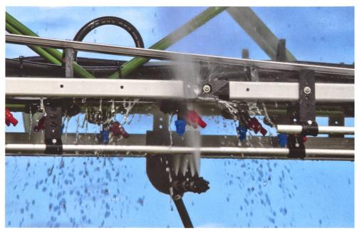
Die Hochdruckdüsen werden am Auslegerpaket entlanggefahren und reinigen effektiver als jede manuelle Reinigung. Mit dem BoomWash-System von Amazone wird es dem Anwender wesentlich erleichtert, die Reinigung des Gestänges auf dem Feld durchzuführen. Die Austräge in die Umwelt durch Abwaschen des Gestänges in sensiblen Bereichen oder auf dem Hof werden dadurch vermindert.
