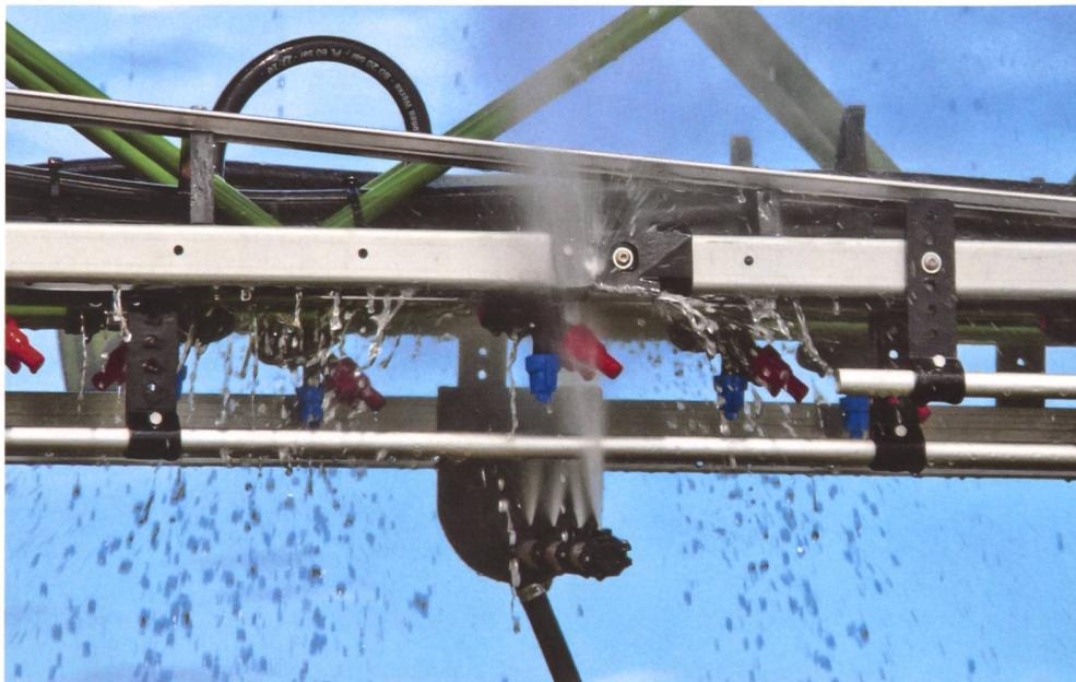
Die Hochdruckdüsen werden am Auslegerpaket entlanggeföhrt und reinigen effektiver als jede manuelle Reinigung. Mit dem BoomWash-System von Amazone wird es dem Anwender wesentlich erleichtert, die Reinigung des Gestänges auf dem Feld durchzuführen. Die Austräge in die Umwelt durch Abwaschen des Gestänges in sensiblen Bereichen oder auf dem Hof werden dadurch vermindert.
