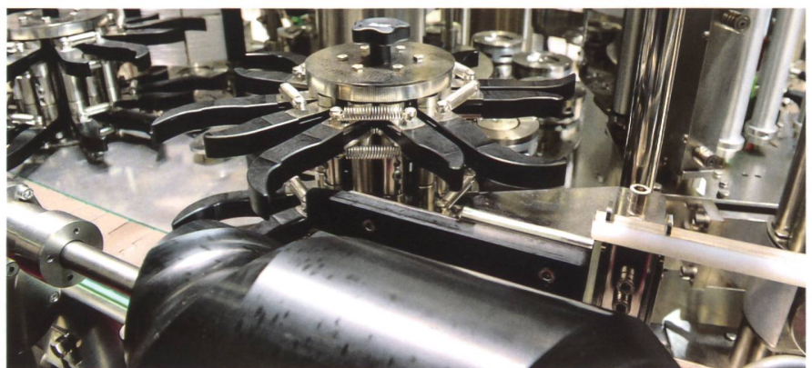
Mit der neuen Abfüllmaschine von GAI können Flaschendurchmesser zwischen 60 und 115 mm verwendet werden. Dank den zwei voneinander unabhängigen Greifzangen ist auch die Arbeit mit konischen Flaschen möglich.
