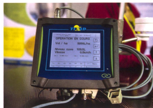
Diese elektronische Einrichtung im Angebot der Firma Tixad aus Montpellier ist auf eine kontrollierte Anwendung der Pflanzenschutzmittel mit der entsprechenden Nachverfolgbarkeit ausgerichtet.
