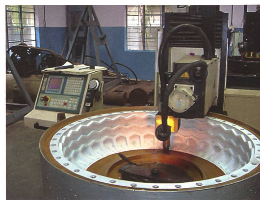
«Backform» für einen AW-Rohling. Die Vulkanisation dauert je nach Grösse 30 bis 150 Minuten.
