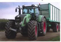
tion mit dem speziellen Flotation-Trac-Profil für gute Selbstreinigung, Stabilität, gleichmässige Druckverteilung in der Aufstandsfläche, lange Lebensdauer, niedrigen Rollwiderstand und Fahrkomfort bei Geschwindigkeiten bis zu 65 km/h. Der Flotation Trac wurde speziell für Silagewagen, Kipper und Gülletankwagen entwickelt.
