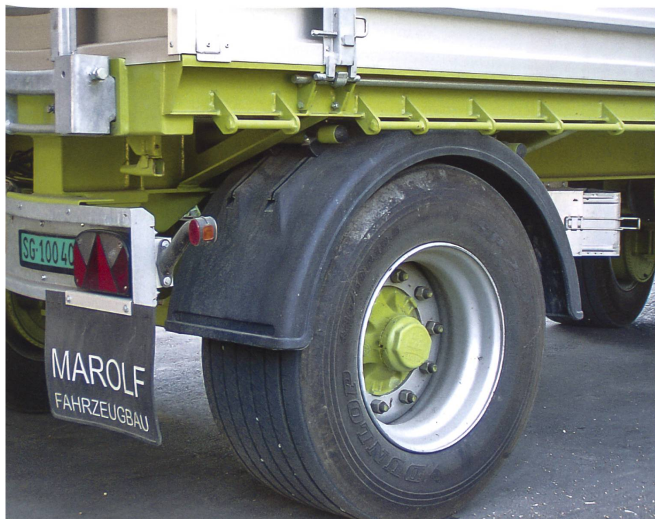
Dieser Strassenreifen erfordert einen hohen Reifendruck und bietet dafür einen niedrigen Rollwiderstand. (Bilder Ruedi Hunger)
