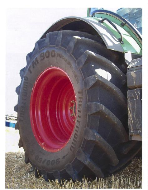
TM Blue Technologie für mehr Aufstandsfläche und Traktionsvermögen.
