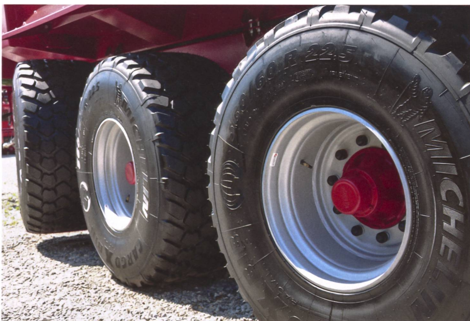
Bei Twin-Radial-Reifen ist die Stollenhöhe verantwortlich für die Abrollgeräusche auf der Strasse.
