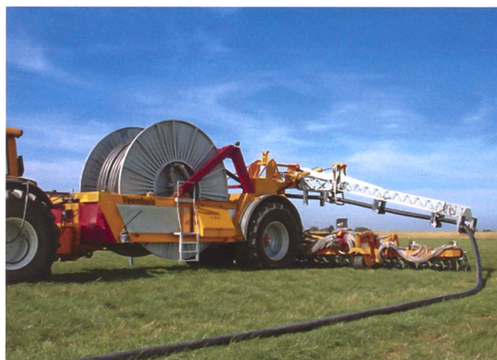
Der «Rotomax-Güllehaspel» von Veenhuis ermöglicht es dank langem Arm, Scheibeninjektoren mit Verschlauchung einzusetzen. Dies könnte auch ein Denkansatz für den Selbstfahrer sein. (Bild zVg)
