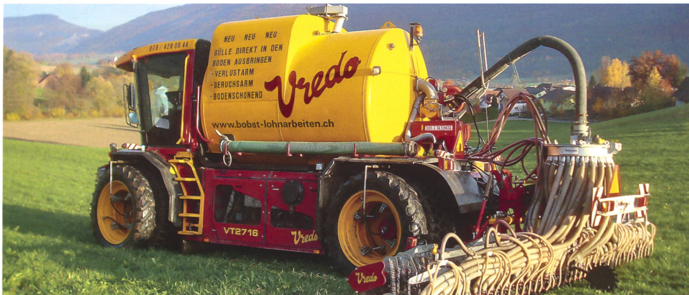
Der Vredo-Selbstfahrer von Andreas Bobst ist mit einem Krummenacher-Sägerät mit 41 Abgängen ausgerüstet. (Bild: Andreas Bobst)
