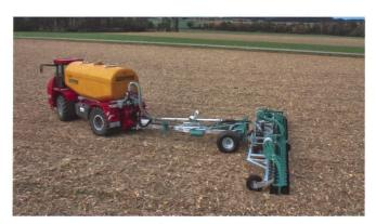
Mit dieser Neuentwicklung, dem angehängten Scheibeninjektor «Zunidrill Mobil», ist es Zunhammer gelungen, die hintere Achslast des Selbstfahrers bedeutend zu reduzieren. (Bild zVg)
