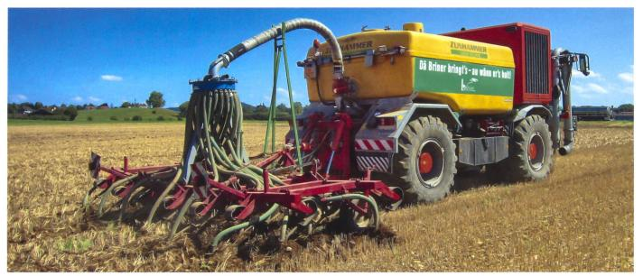
Der Holmer von Peter Briner wird nach der Ernte mit einem Güllegrubber eingesetzt, im Frühling und Herbst auch mit Schleppschlauchverteiler.
