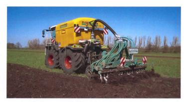
Kurzscheibeneggen erfordern Fahrgeschwindigkeiten von 12 bis 15 km/h und somit viel Motorleistung. (Bild zVg)
