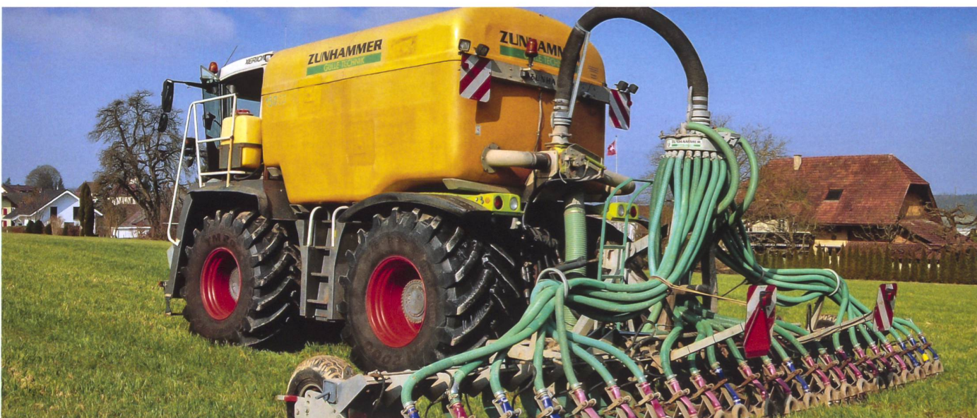
Das Systemfahrzeug Claas Xerion von Markus Schneider kommt mit Scheibeninjektor und Kurzscheibenegge zum Einsatz. (Bild: Ruedi Burkhalter)
