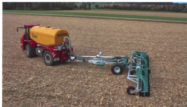
Mit dieser Neuentwicklung, dem angehängten Scheibeninjektor «Zunidrill Mobil», ist es Zunhammer gelungen, die hintere Achslast des Selbstfahrers bedeutend zu reduzieren. (Bild zVg)
