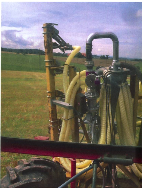
Für die Mengenerfassung ist bei der Gülle-Unterfussdüngung ein Mengenmesser zu empfehlen. (Bild: M. Häberli)
