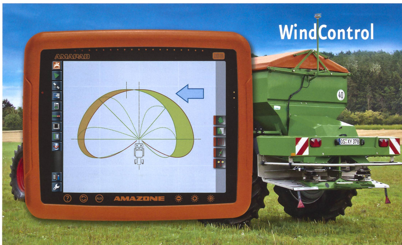
Mithilfe einer speziellen Software werden die einwirkenden Windeinflüsse und die notwendigen Verstellmassnahmen berechnet.
