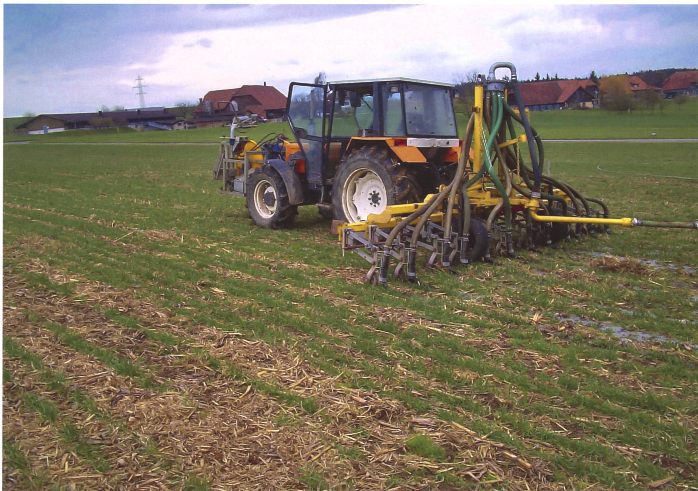
Der Gülleinjektor von Martin Häberli ist mit Scheibenelementen von Veenhuis ausgerüstet. (Bild: M. Häberli)
