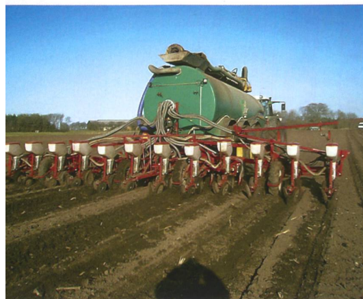
Dieses in Dänemark im Einsatz stehende Tridem-Güllefass erledigt die Gülle-Unterfussdüngung und die Maissaat 12-reihig in einem Arbeitsgang. (Quelle: www.langelundaps.dk)
