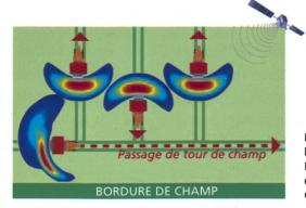
Illustration zur Stop&go-Vorrichtung bei den Sulky-Düngerstreuern der Baureihe X12-44 als ein Beispiel aus der Vielfalt der automatisierten Grenzstreueinrichtungen.
