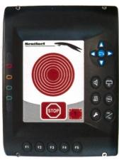
Herzstück des «Sentinel», einer Art Fahrerassistenzsystem, ist der Multisensor mit eingebauten Neigungssensoren und GPS. Über den Monitor (Abbildung) werden einerseits die Daten u.a. von den Anbaugeräten erfasst und andererseits die Informationen des «Sentinel»-Sensors übermittelt. Rote Kreise bedeuten eine grosse Kippgefahr; sind sie grün, ist alles i.O. So gibt das Gerät wertvolle Hinweise über die Befahrbarkeit in schwierigem Gelände.
