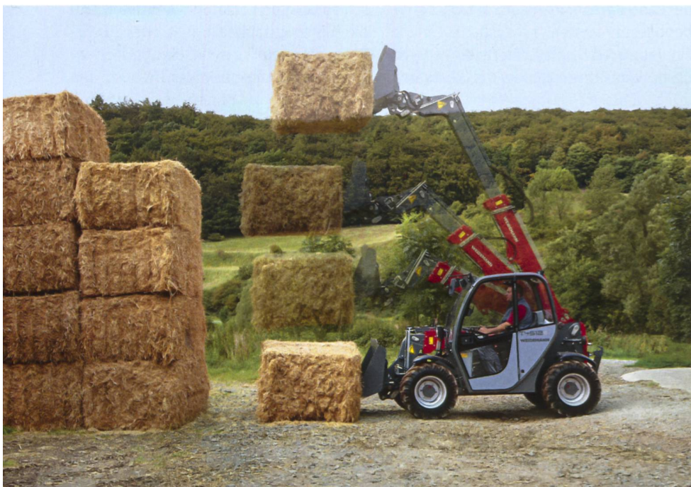
Der entscheidende Vorteil des neuen Vertikal-Lift-Systems (VLS) von Weidemann ist die annähernd vertikale Senkbewegung des Teleskoparms, die zu einer wesentlichen Verbesserung der Standsicherheit der Maschine führt.
