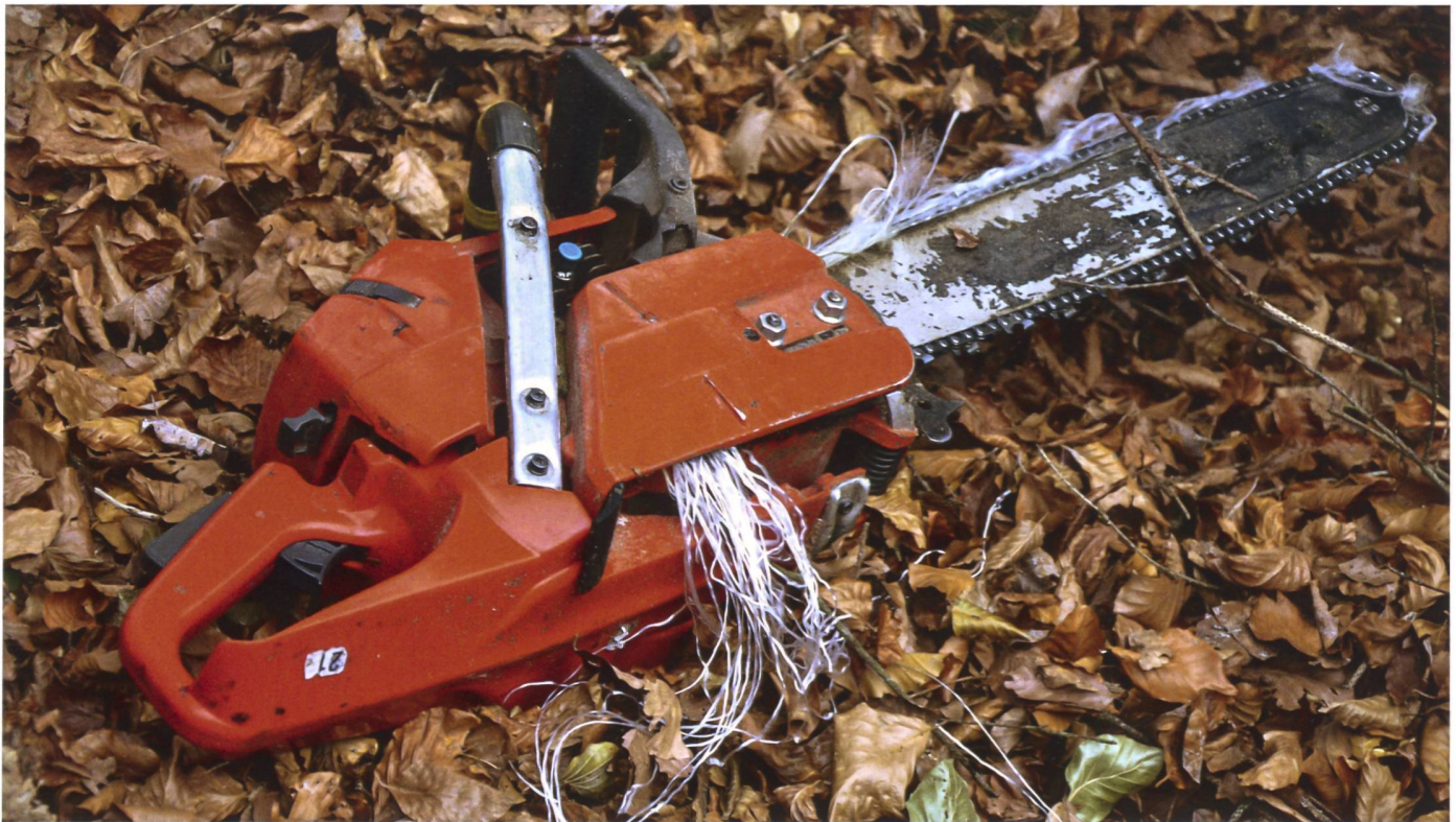
Die Schnittschutzhose blockierte die Motorsäge augenblicklich, ohne eine Beinverletzung zu verursachen.
