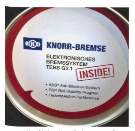
Verschiedene Hersteller bauen neuerdings die aus dem Lastwagenbereich stammenden elektronischen Bremssysteme (EBS) mit ABS, Automatisch lastabhängige Bremse (ALB) und Roll-Stabilitätssystemen in landwirtschaftliche Anhänger ein. Damit wird mehr Sicherheit bei hohen Fahrgeschwindigkeiten, engen Kurven und Bremsmanövern geboten.
