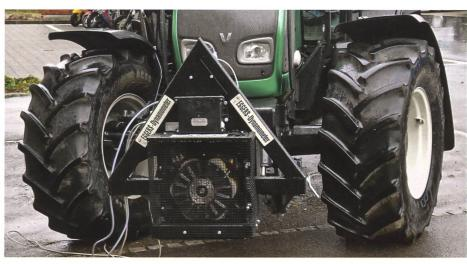
Der in der Fronthydraulik gekoppelte elektrische Wirbelstromretarder ermöglicht die verschleisslose Bremsung eines landwirtschaftlichen Anhängerzuges. Problematisch ist jedoch, dass nur eine Achse gebremst wird. Der Retarder kann also die Betriebsbremse nicht ersetzen, nur ergänzen.
