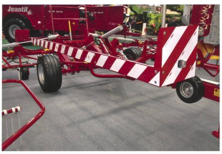
Neue Modelle der gezogenen Kreiselheuer, im Bild ein Modell von SIP, sind mit einer seitlichen Abdeckung versehen, sodass Spitzen zum grössten Teil abgedeckt sind.
