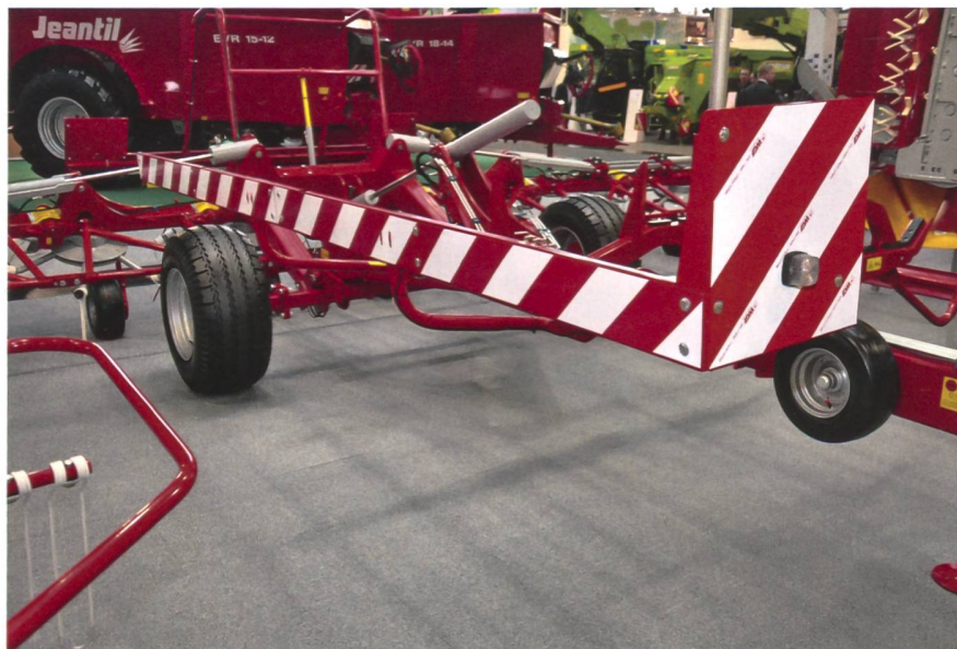
Neue Modelle der gezogenen Kreiselheuer, im Bild ein Modell von SIP, sind mit einer seitlichen Abdeckung versehen, sodass Spitzen zum grössten Teil abgedeckt sind.
