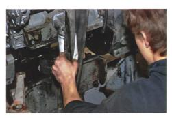
Die an Gurten aufgehängte Motorölwanne hat neue Dichtungen erhalten; sie wird unter dem Traktor passgenau platziert.
