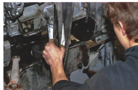
Die an Gurten aufgehängte Motorölwanne hat neue Dichtungen erhalten; sie wird unter dem Traktor passgenau platziert.
