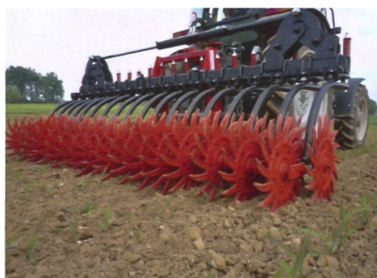
Der Moro Krustenbrecher hat mit 8–12 km/h eine hohe Flächenleistung. (Vertretung GVS-Fried AG, Koblenz)
