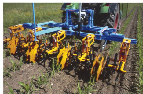
Schmotzer Scharhacke für Heckanbau: Die Zahnschutzrolle ist jeweils am Parallelogramm befestigt und lässt sich hochklappen, wenn die Pflanzen genügend gross sind. (Vertretung GVS-Fried AG, Koblenz)
