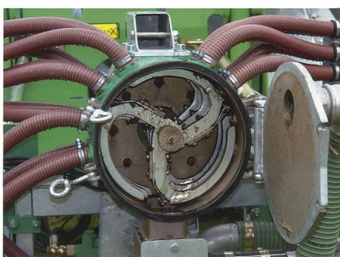
Der Verteilkopf wird als Herz des Schleppschlauchverteilers und seiner Weiterentwicklungen bezeichnet.
