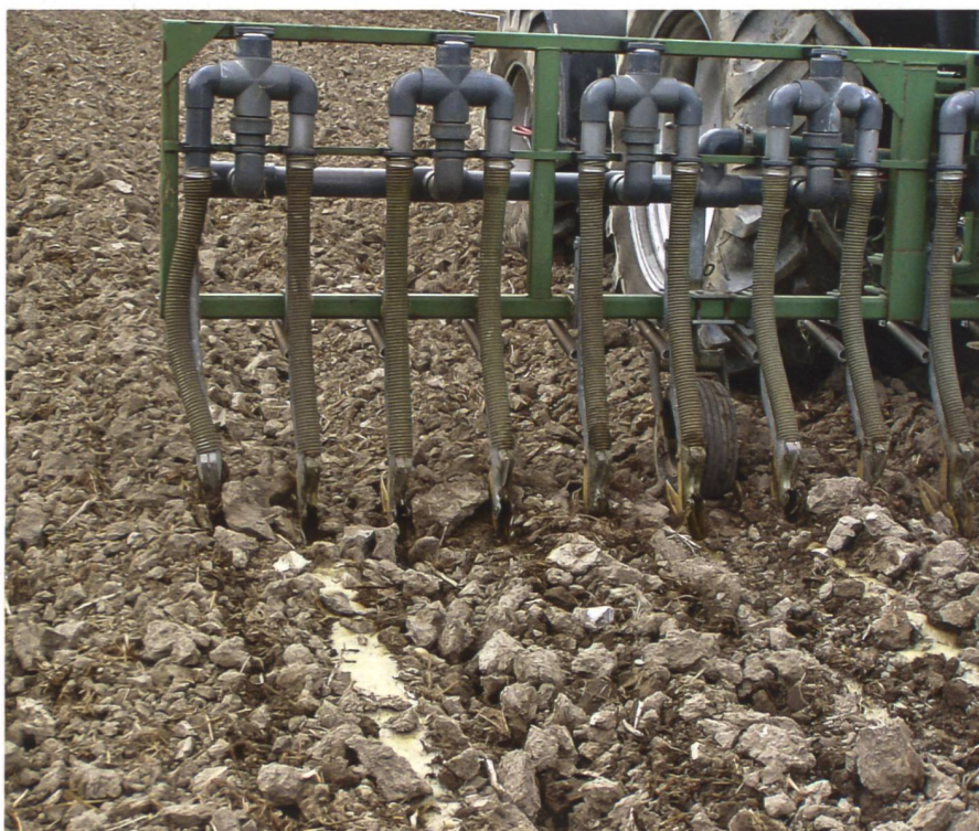
In vorbereiteten Böden verschwindet die Gülle über die Schleppschuhtechnik rasch.
