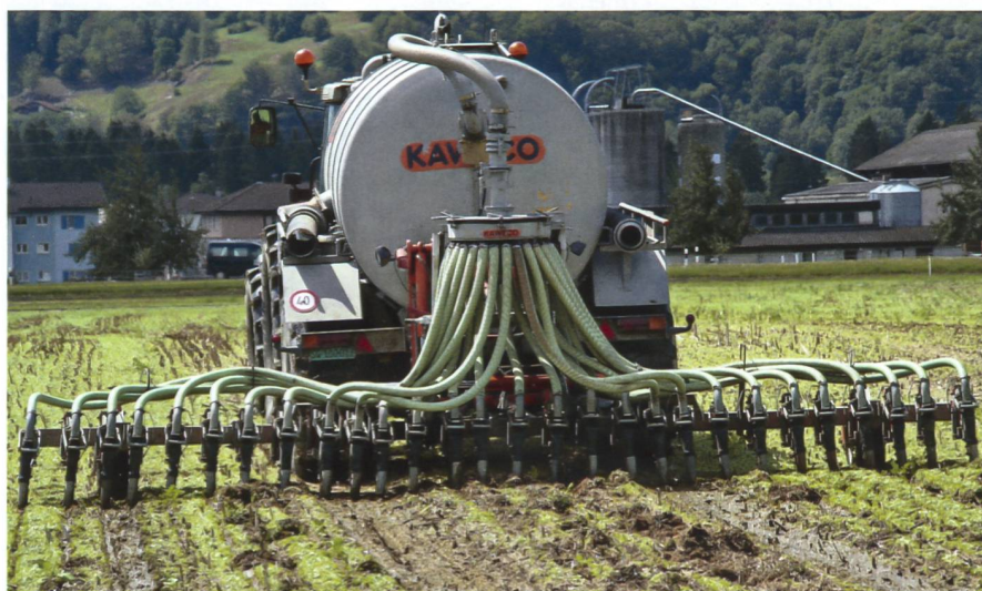
Im Vergleich zum Schleppschlauchverteiler kann der Schleppschuhverteiler in der Regel weniger breit gebaut werden.
