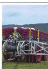
Schleppschlauchverteiler und Gülleverschlauchung im Kampf gegen Stickstoffverluste beziehungsweise Bodendruck.
