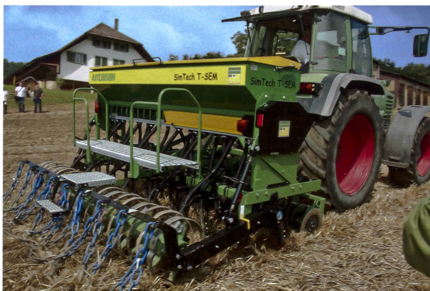
Aitchison Grassfarmer: einfache und effiziente Spezialmaschine für Wiesenansaat.
