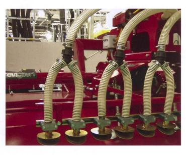
Bei Sägeräten, die nach dem Prinzip «Krummenacher» gebaut sind, wird das Saatgut mechanisch dosiert, pneumatisch transportiert und über Prallbleche verteilt.
