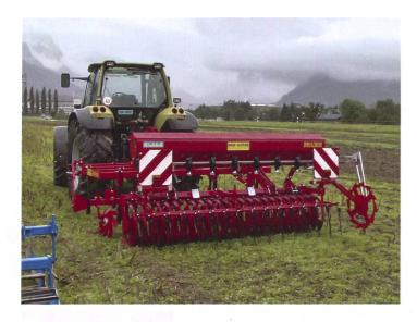
Einfache Dosiertechnik für den Aufbau auf ein starres Bodenbearbeitungsgerät. (Werkfoto: Einböck)
