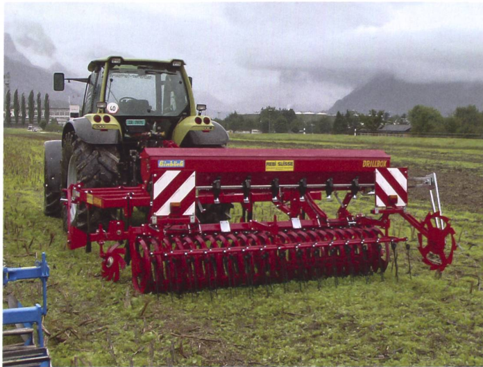
Einfache Dosier- technik für den Aufbau auf ein starres Bodenbear- beitungsgerät.
