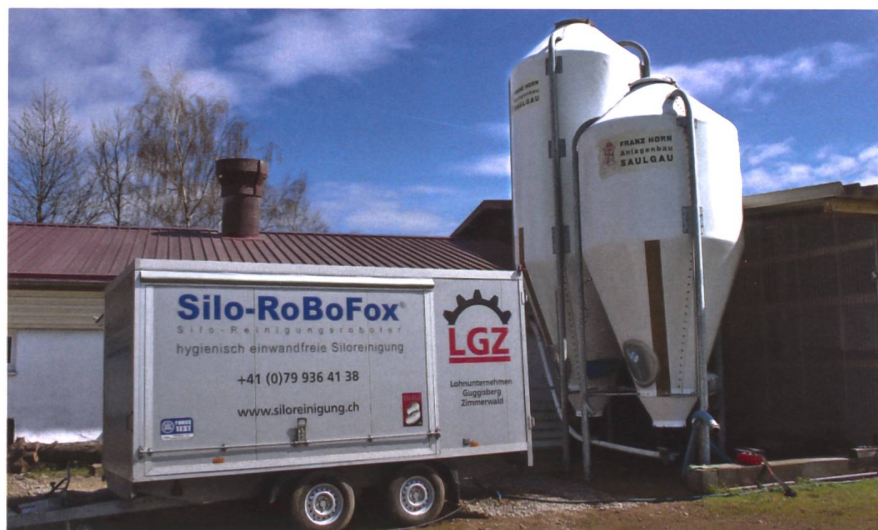
Kompakt verpackt alles zur professionellen computergesteuerten Siloreinigung und zum Lukenbau ist in diesem Anhänger verbaut. An den Silos sichtbar die eingebaute Luke.
