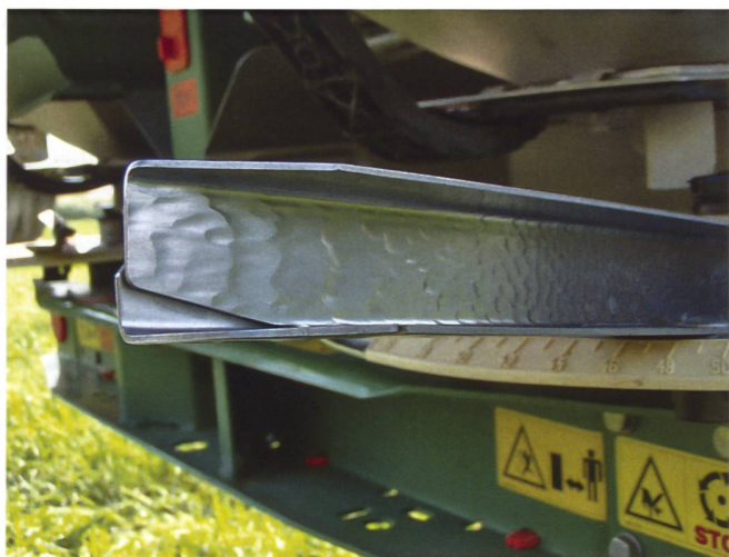
Je nach verwendetem Dünger entstehen merkliche Verschleisserscheinungen an den Wurfschaufeln.
