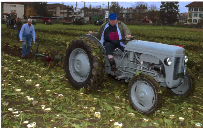
Der Tüscherpflug wird von einem MF TED gezogen.
