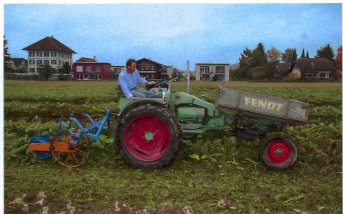
Der dreireihige Traktorkörper am Fendt GT 220 von 1962.
