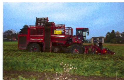
Der selbstfahrende sechsstufige Zuckerrübenvollernter Holmer Terra Dos T3 plus des Rübenerntebetriebs Brauen & Friederich in Suberg BE.
