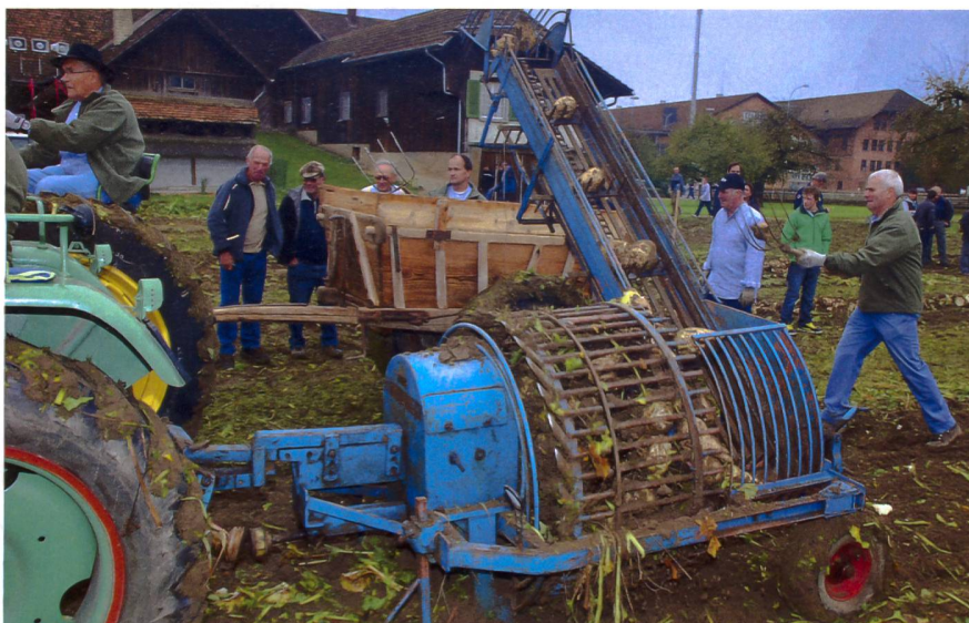
Der Stegsteg transportiert die Rüben in Ueli Stämpflis Bangerter-«Schnellbänä».
