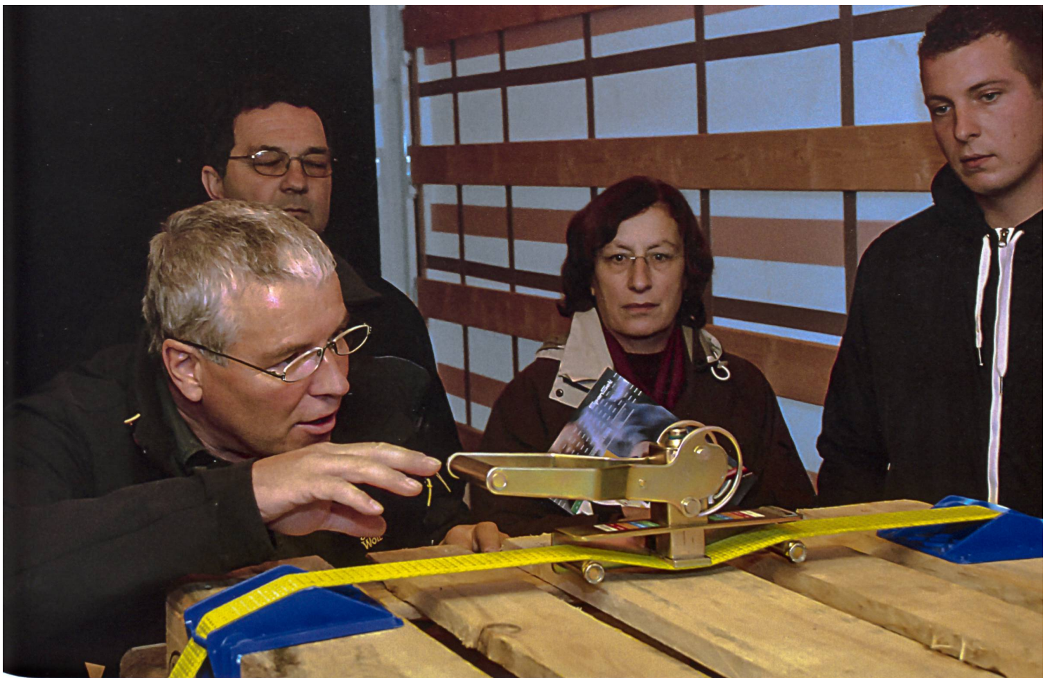
Kursleiter Fritz Mühlemann misst die Vorspannkraft eines Spannelements; Kantengleiter sorgen für eine gleichmässige Verteilung der Vorspannkraft auf beide Ladungsseiten. (Bilder: Dominik Senn)
