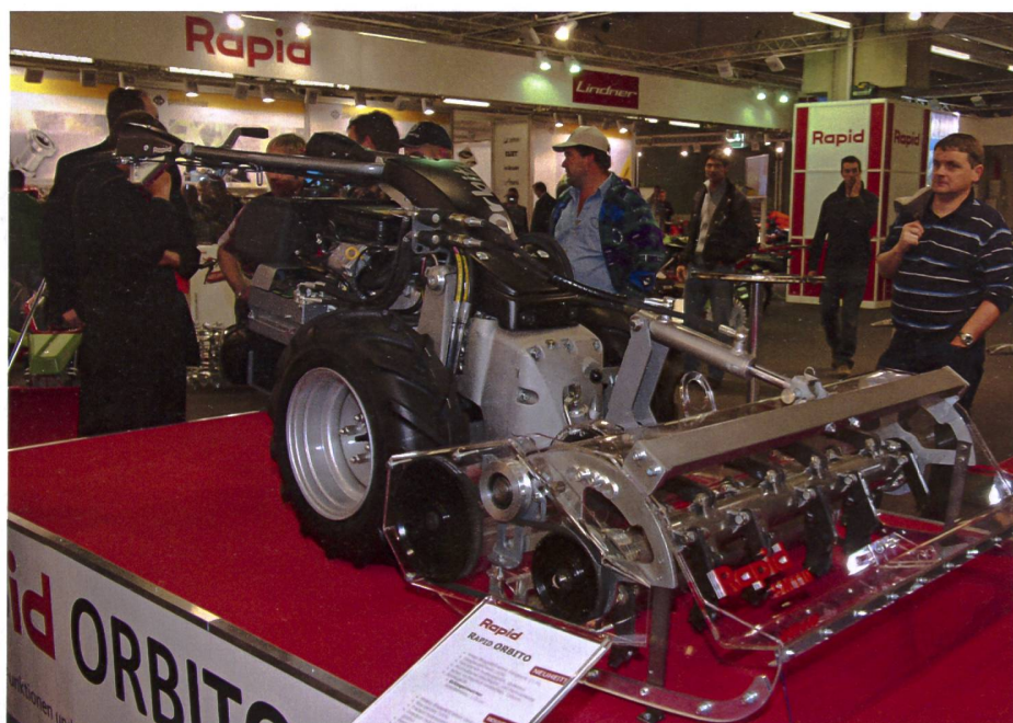
Rapid Orbito mit Achsverstellung für eine optimierte Gewichtsverteilung. (Bilder: Ruedi Burkhalter)
