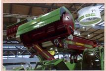
Das mit einer Silbermedaille prämierte Futterentnahmesystem für selbstfahrende Futtermischwagen der Firma Strautmann kombiniert die Vorteile der bekannten Systeme Schneidschild bzw. Blockschneider und Fräse. Während die Silage strukturschonend mit einem Schneidschild aus dem Silo gelöst und ohne mechanische Belastung über eine stumpfe, mit Schneckensegmenten bestückte Förderwalze zum Elevatorband befördert wird, können durch Abklappen
