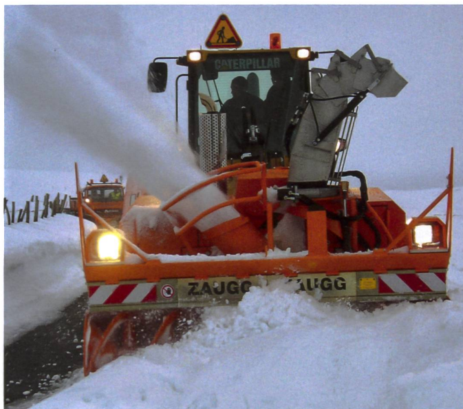
Hoher Kraftbedarf beim Einsatz einer Schneeschleuder schlägt sich beim Treibstoffverbrauch nieder. (Bild zVg)
