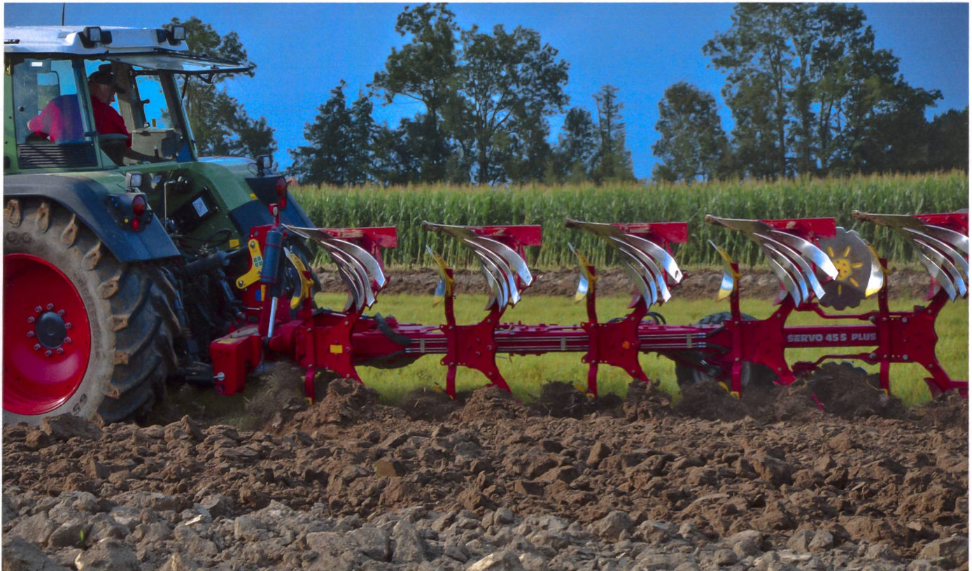
Die bisherige Lehrmeinung zur Bodenverdichtung im Bereich der «Pflugsohle» muss differenziert beurteilt werden. Es kommt nicht zwangsläufig zur Gewichtsverlagerung Richtung Furchenrad. (Bild: Ruedi Hunger)
