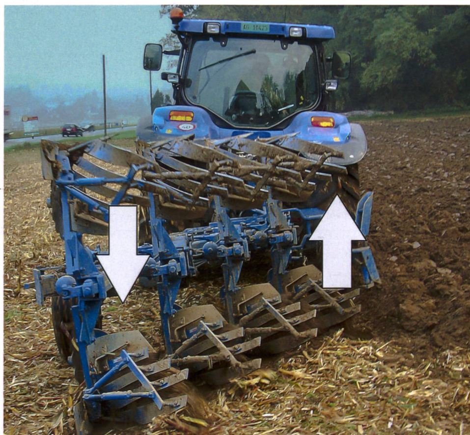
Der Angriffspunkt der Vertikalkraft beim Pflug verschiebt sich mit wachsender Arbeitsbreite vom Furchenrad zum Landrad. (Bild: Ueli Zweifel)
