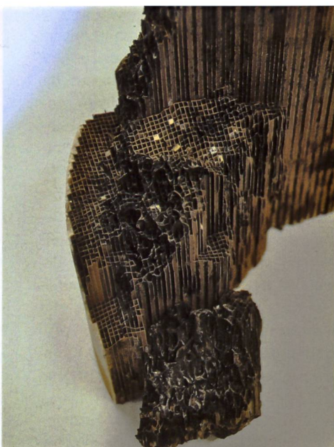
Partikelfilter setzen sich sehr schnell mit Sulfatasche zu, wenn nicht die richtigen Motorenöle verwendet werden.
