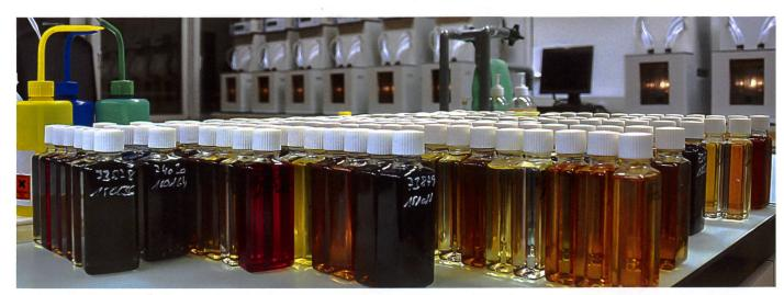
Die Diversifizierung bei den Ölsorten nimmt stetig zu. Bei Motorex wird von jeder Produktionscharge eine Probe entnommen und analysiert.
