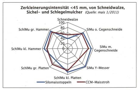
Die Zerkleinerungsintensität wird durch die Werkzeuggeschwindigkeit und die Rotordrehzahl bestimmt. Geräte mit einer Gegenschneide erzielen bessere Resultate. Die Schneidwalze wurde als Vergleichsgerät im Testeinsatz eingesetzt.
