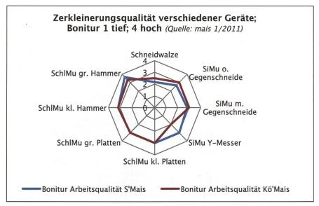
Die Qualität der Zerkleinerung bestimmt die Verrottung und beeinflusst die Überwinterungsmöglichkeiten bei Pilz- und Maiszünslerbefall. Platten- und Hammerschlegel erreichen fast identische Boniturwerte.
