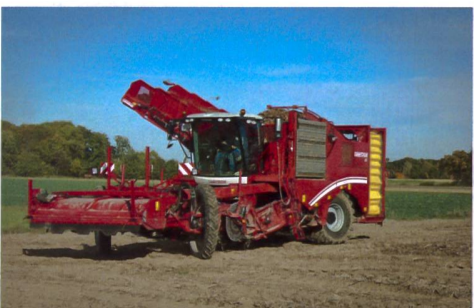
Der VARITRON 470 neu mit Radfahrwerk statt Raupen.
