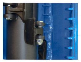
«Schikanen» wie diese Zahnleiste verbessern den Aufschluss, erhöhen aber den Kraftbedarf.
