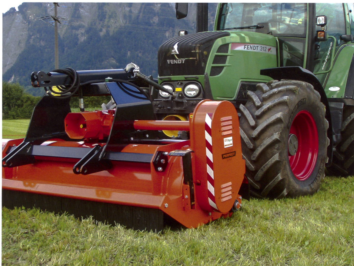
Im Frontanbau wird weniger Pflanzenmasse niedergewalzt. Dies bedeutet einen besseren Mulcheffekt. (Bilder: Ruedi Hunger)
