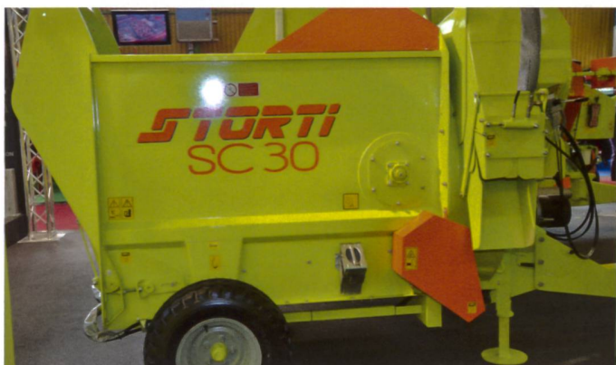
Dieses Gerät nimmt heckseitig die Rundballen, löst sie auf und verteilt das Futter entlang der Futterachse. Geräte mit einer Turbine können auch zum Einstreuen verwendet werden.
