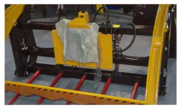
Kleines Detail mit grosser Wirkung: Eine Klemmvorrichtung fixiert nach dem Schnitt der Rundballe Folie und Netz, diese können anschliessend ohne grossen Aufwand entfernt werden.
