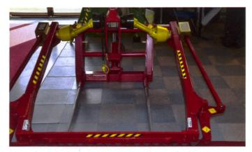
Die mechanische Variante: Gegenläufige Messer schneiden die aufgenommene Rundballe entzwei, die Verteilung erfolgt nach wie vor von Hand.
