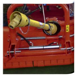
Auf Wunsch ist eine seitliche Verschiebung möglich. Diese ist besonders beim Mulchen von Maisstoppeln sinnvoll, wenn unter Ausnutzung der ganzen Arbeitsbreite das Überfahren der Stoppel verhindert werden soll.
