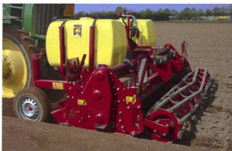
Die Grimme GR 300 hat 110 Zinken und arbeitet mit hoher Rotordrehzahl. (Werkbilder)
