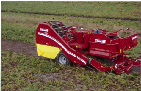
Der zweireihige Bunkerroder SE 260 wiegt 9,2 t.
