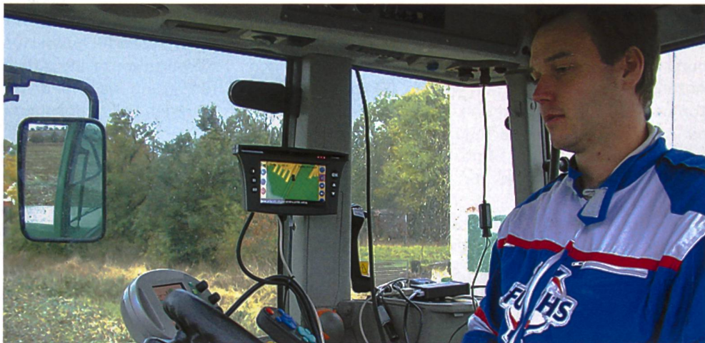
Agroscope untersuchte den arbeitswirtschaftlichen und ergonomischen Nutzen präziser automatischer Lenksysteme. (Foto: M. Kroulik)
