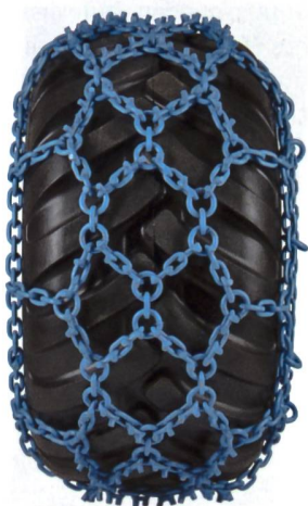
Eine Forstkette, die sich durch eine asymmetrische Anordnung der «Stacheln» auszeichnet. Laut Hersteller ist diese Kette für extreme Verhältnisse im Forsteinsatz geeignet.
