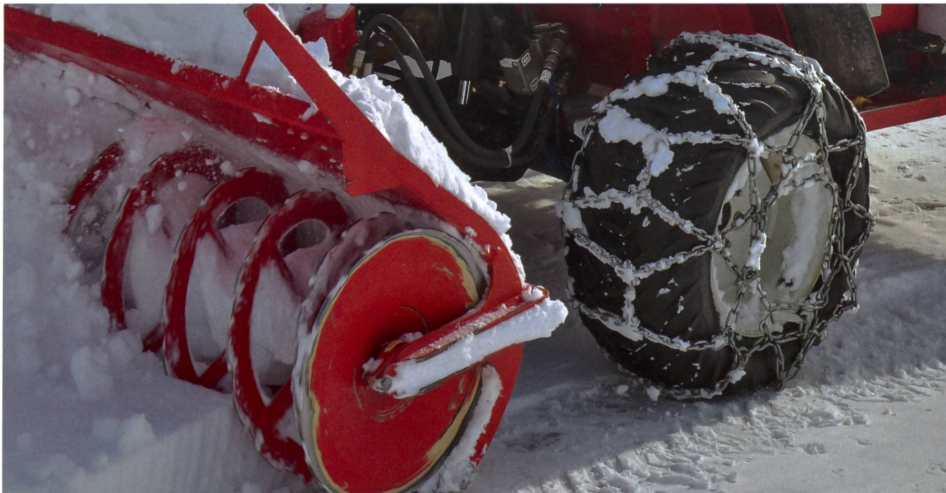
Schneeketten ermöglichen das Fahren auf Schneefahrbahnen. Gleichzeitig verbessern sie die Bremswirkung und ermöglichen eine saubere Seitenführung. (Bilder: Ruedi Burkhalter)
