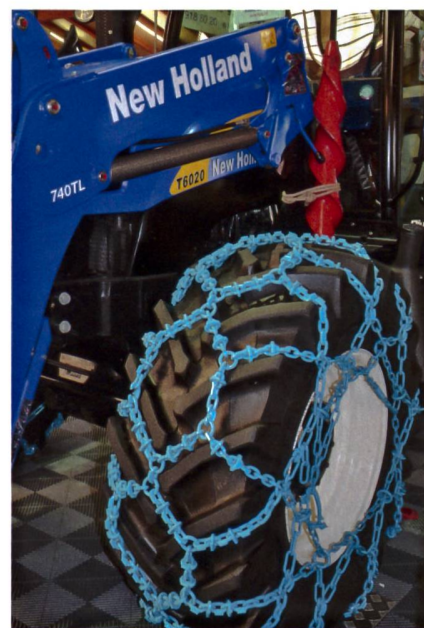
Diese Kette aus Vierkant-Stahlringen hat zusätzlich auf jedem Ring einen Verschleissstab aus hochwertigem Stahl aufgeschweisst. Sie zeichnet sich aus durch Laufruhe und optimalen Griff auf schwieriger Fahrbahn.
