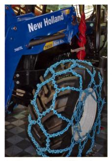
Diese Kette aus Vierkant-Stahlringen hat zusätzlich auf jedem Ring einen Verschleissstab aus hochwertigem Stahl aufgeschweisst. Sie zeichnet sich aus durch Laufruhe und optimalen Griff auf schwieriger Fahrbahn.
